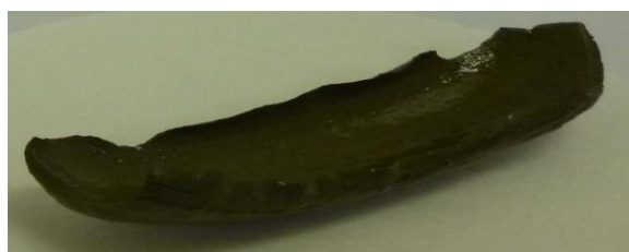
Рисунок 7 – Внешний вид пластин после 6 часовой обработки азотной кислотой
