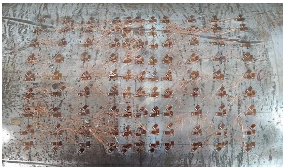
Рисунок 2 - Установленные в области вмятины группы тензодатчиков
