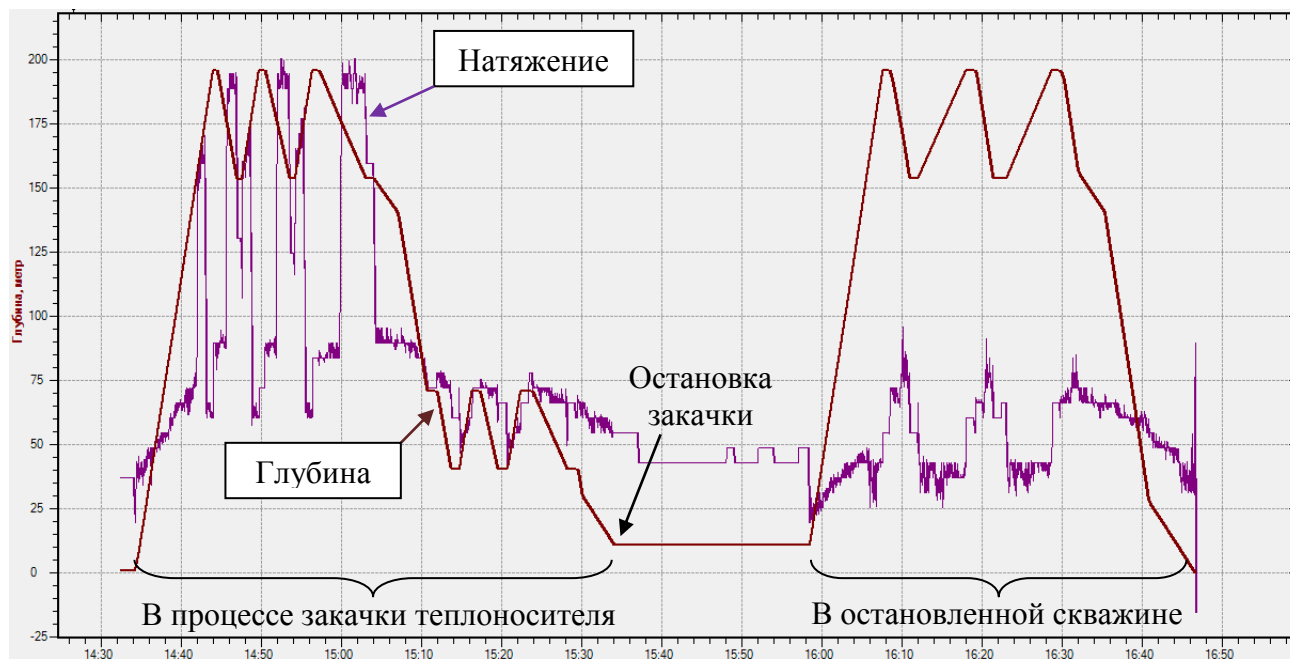
Рисунок 2 – Спуско-подъёмные операции с натяжением проволоки
