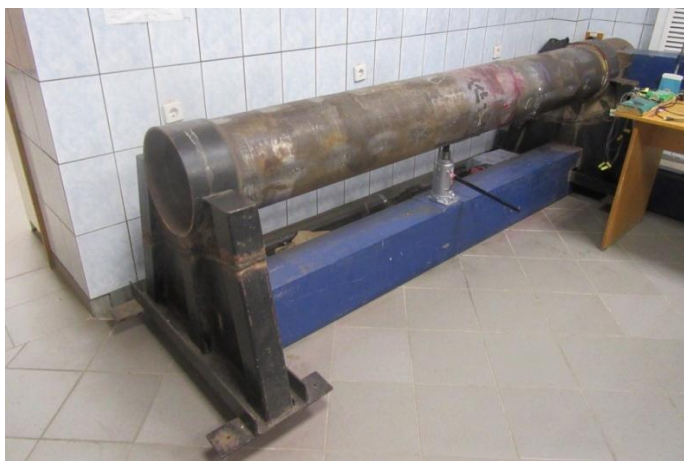
Рисунок 1 - Внешний вид лабораторного стенда для исследования напряжённо-деформированного состояния трубы при воздействии нагрузок
