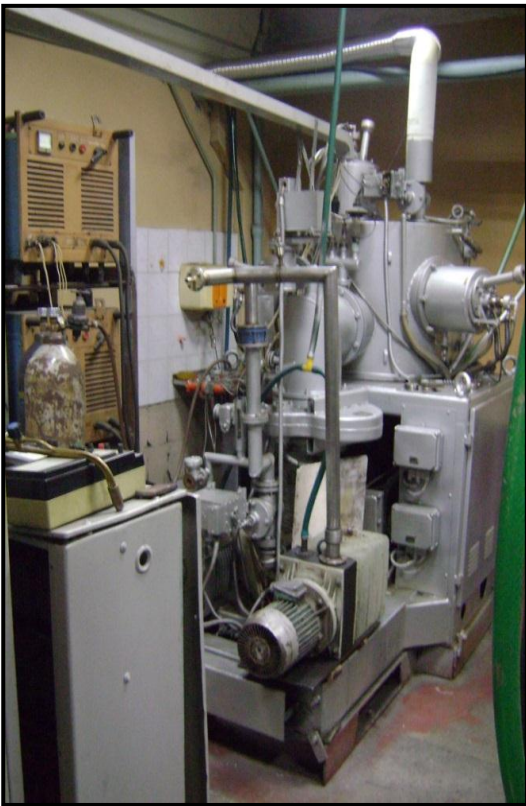
Рисунок 4 - Общий вид вакуумной ионно-плазменной установки ННВ 6,6 – И1 для напыления ФОП лопаток ГТП
