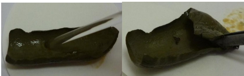
Рисунок 8 – Внешний вид пластин после 24 часов обработки азотной кислотой Через 4 суток обработки азотной кислотой образцы разрушились полностью. Обработка осадка раствором гипохлорита натрия. Образцы осадка были помещены в раствор гипохлорита натрия (рисунок 10).
