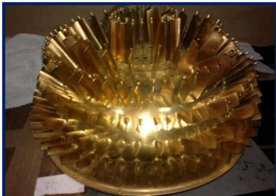
Рисунок 5 - Общий вид сферической оснастки вакуумной камеры для напыления поворотных лопаток компрессора направляющего аппарата ГТП
