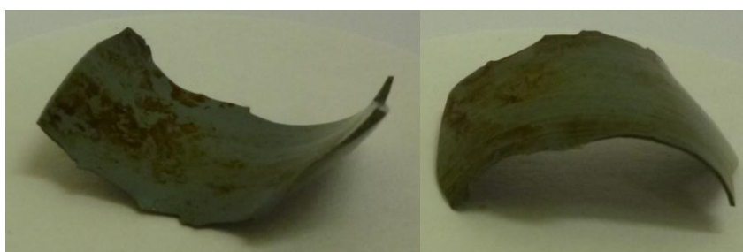
Рисунок 12 – Внешний вид пластин после обработки гипохлоритом натрия 8 часов
