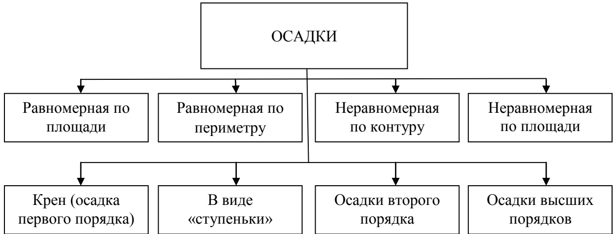
Рисунок 1.8 – Виды осадок оснований резервуаров
