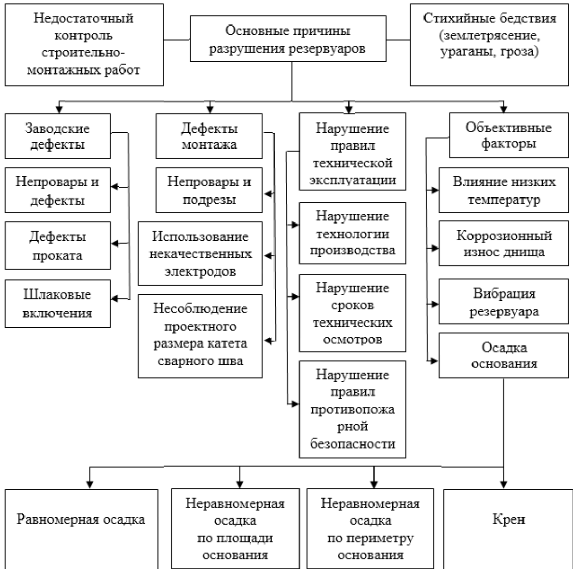
Рисунок 1.6 – Причины разрушения РВС по В. Б. Галееву [33]
