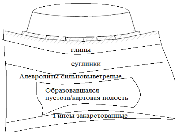
Рисунок 1.17 – Прогиб и растрескивание фундаментной плиты
