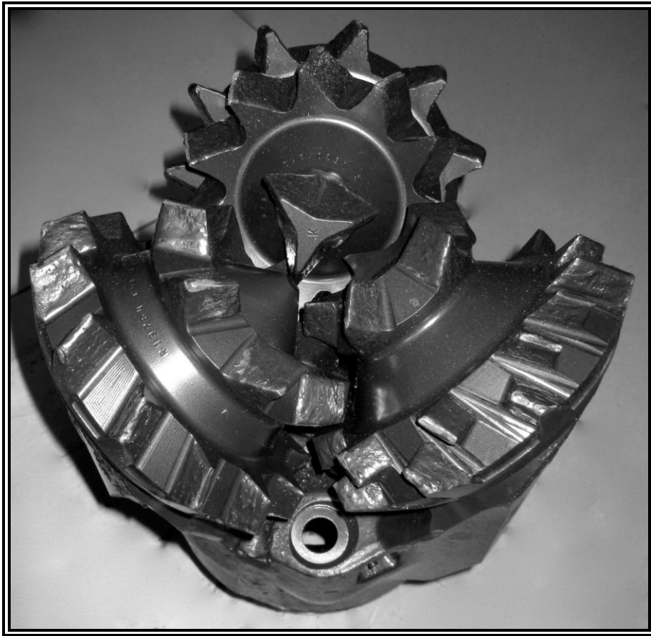
Рисунок 6.25 - Трехшарошечное долото П295,3М-ЦГВ с разнонаправленным косо зубым вооружением
