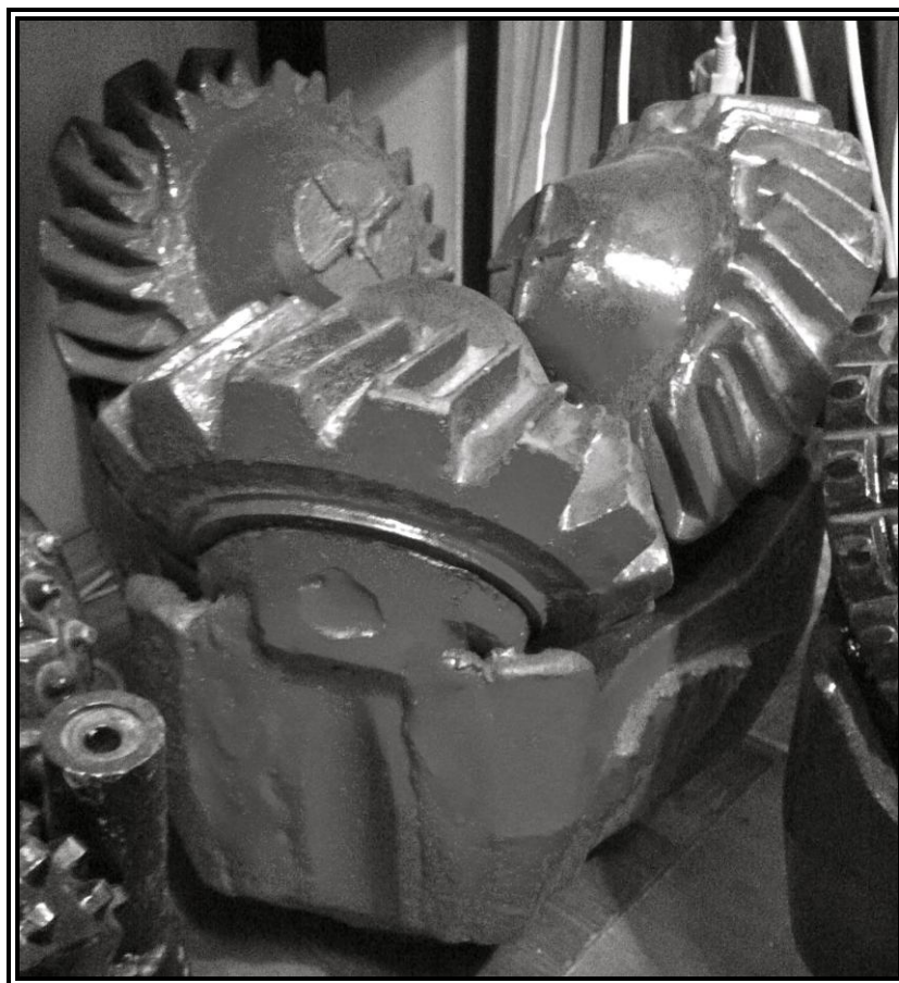
Рисунок 6.23 - Трехшарошечное долото П490С-ЦВР-1 для РТБ
