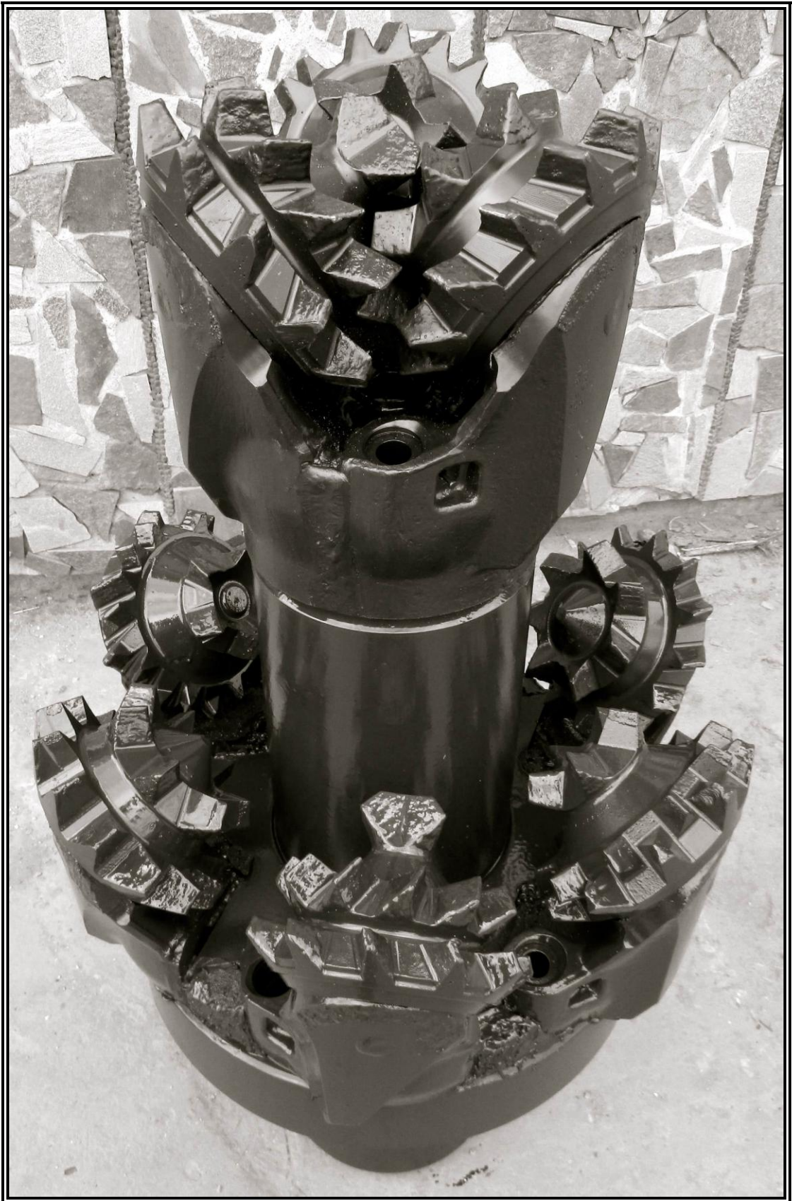
Рисунок 6.27 – Пилотное долото ПД295,3М-ЦГВ и шестишарошечный расширитель 6ШР-555М с разнонаправленным косозубым вооружением
