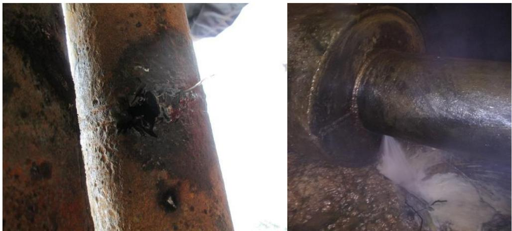
**Рисунок 1.1 – Коррозионное разрушение металла в местах сварных швов на трубопроводе**
