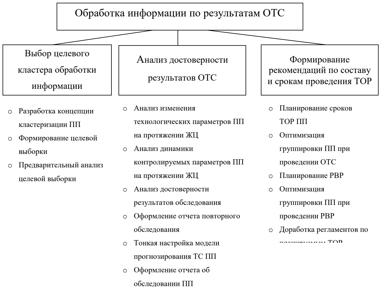
Рисунок 4.1 – Алгоритм обработки информации по результатам обследования технического состояния ПП в процессе кластеризации
