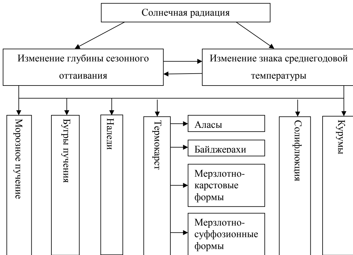
Рисунок 1.3 – Результат воздействия природных факторов на состояние многолетнемёрзлых пород
