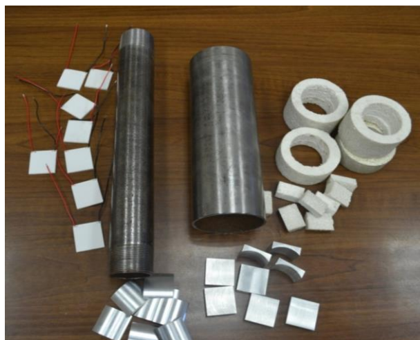
Рисунок 3.27 – Разработанные детали лабораторного образца скважинного термоэлектрического экранного модуля
