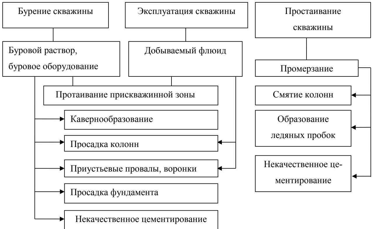
Рисунок 1.2 – Результаты воздействия техногенных факторов на состояние многолетнемерзлых пород в зависимости от жизненного цикла скважины
