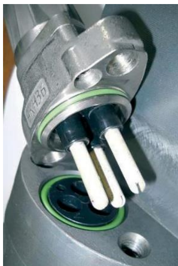
Рисунок 2.4 – Разъемное соединение погружных электродвигателей в УЭЦН
