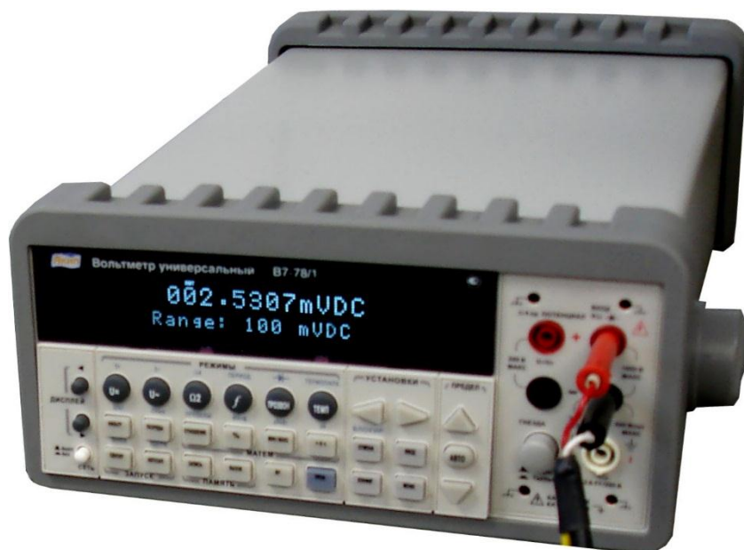
Рисунок 3.5 – Общий вид универсального вольтметра В7-78/1
