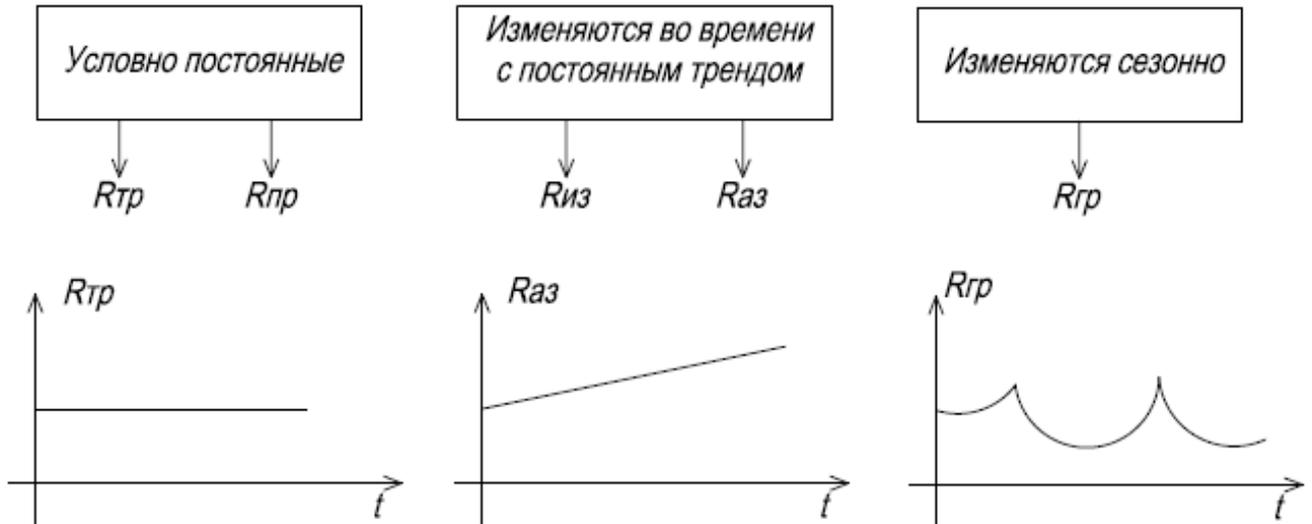
$R_{тр}$ - продольное сопротивление трубопровода;  $R_{пр}$ - сопротивление соединительных проводов;  $R_{из}$ - сопротивление изоляционного покрытия;  $R_{аз}$ - сопротивление анодных заземлений;  $R_{гр}$ - удельное электрическое сопротивление грунта;  $t$ - время
