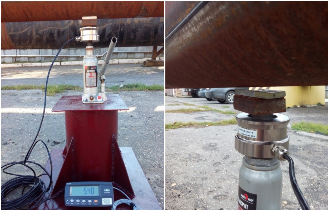
Рисунок 3.6 – Создание поперечного изгиба в ходе выполнения первой группы испытаний
