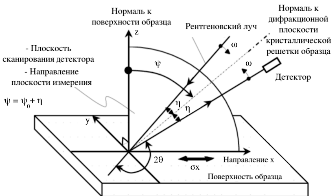
Рисунок 1.11 – Схема, поясняющая принцип определения напряженно-деформированного состояния методом рентгеновской дифрактометрии
