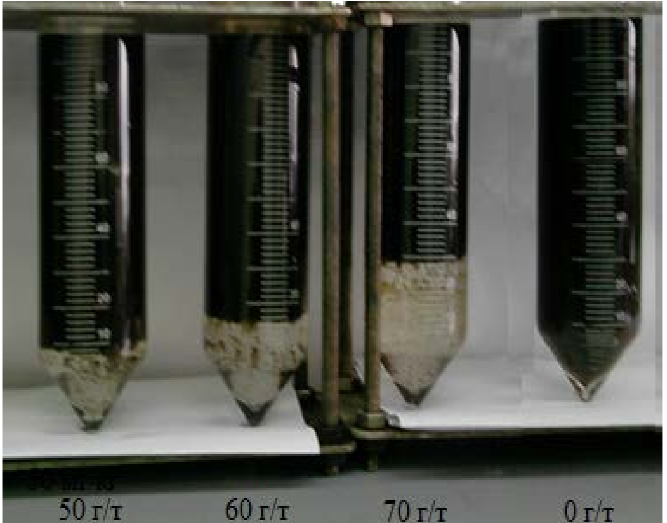
Рисунок 4.6 – Пробы нефти в отстойниках во время испытания Bottle Test
