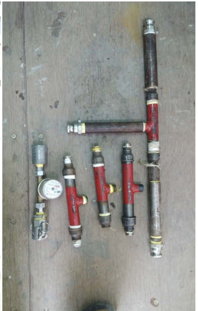
Рисунок 4.15 - Оборудование экспериментального стенда на УПН «Мишриф» а – точка подключения промывной воды с водосчетчиком; б – место подключения экспериментального смесителя; в – действующее оборудование блока обессоливания ТЛ-7 УПН (обессоливатель со штатным смесителем); г – экспериментальные смесители и водосчетчик с коннекторами
