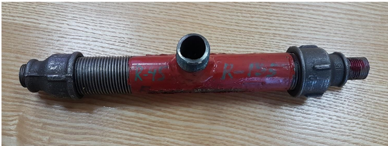
Рисунок 2 - Экспериментальный образец смесителя в сборе на примере R-45 (R-135)
