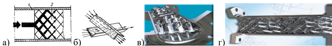
Рисунок 1.20 - Смесители насадочного типа: а – смесительная головка с гофрированными элементами; б - схема потоков в пересекающихся каналах гофрированных пластин; в,г – разрез смесителя, 1– корпус; 2 – пакет гофропластин
