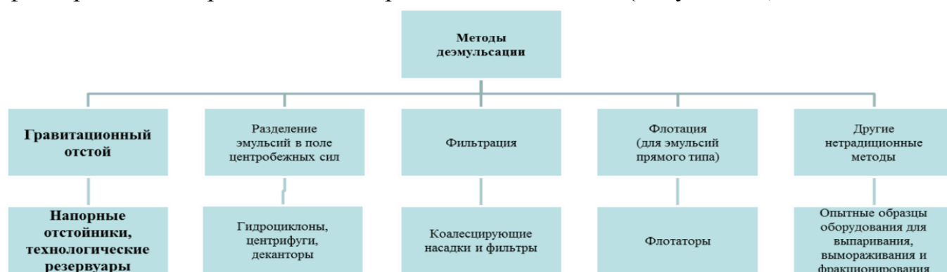
Рисунок 1.3 - Методы и оборудование деэмульсации нефти
