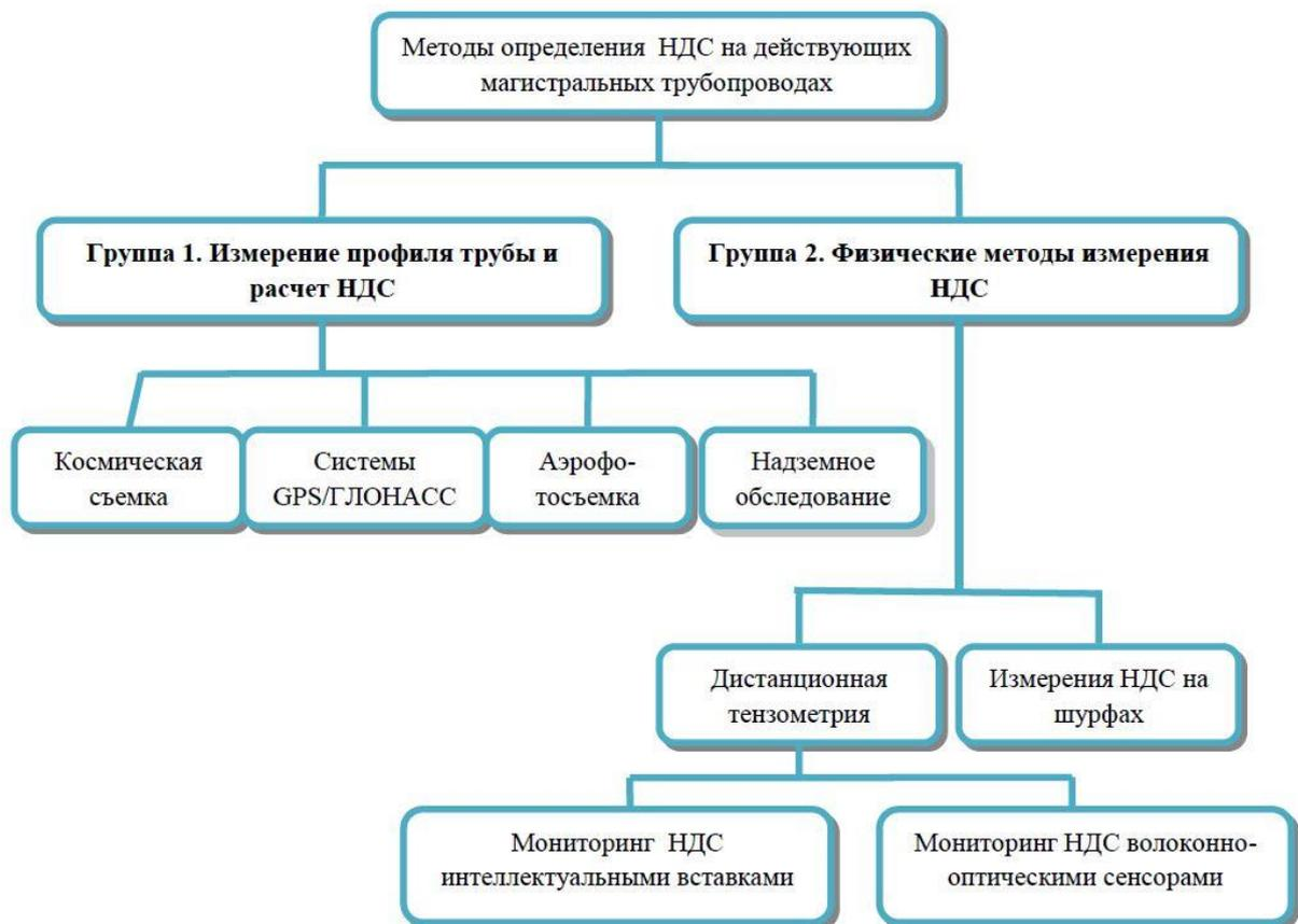
Рисунок 1.8 – Основные методы мониторинга напряженно-деформационных участков трубопровода
