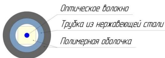
Рисунок 3.3 – Поперечное сечение кабеля ОКЛс
