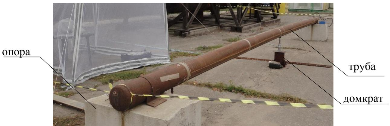
Рисунок 3.1 – Общий вид испытательного стенда
