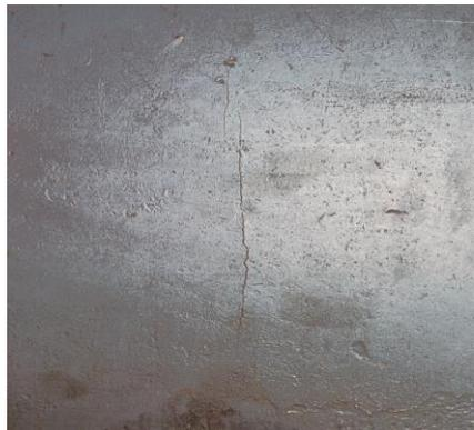
Рисунок 1.7 – Эскиз разрушившегося изгибно-напряженного участка (а) и фотография поперечных трещин металла трубы (б) [1, 97]
