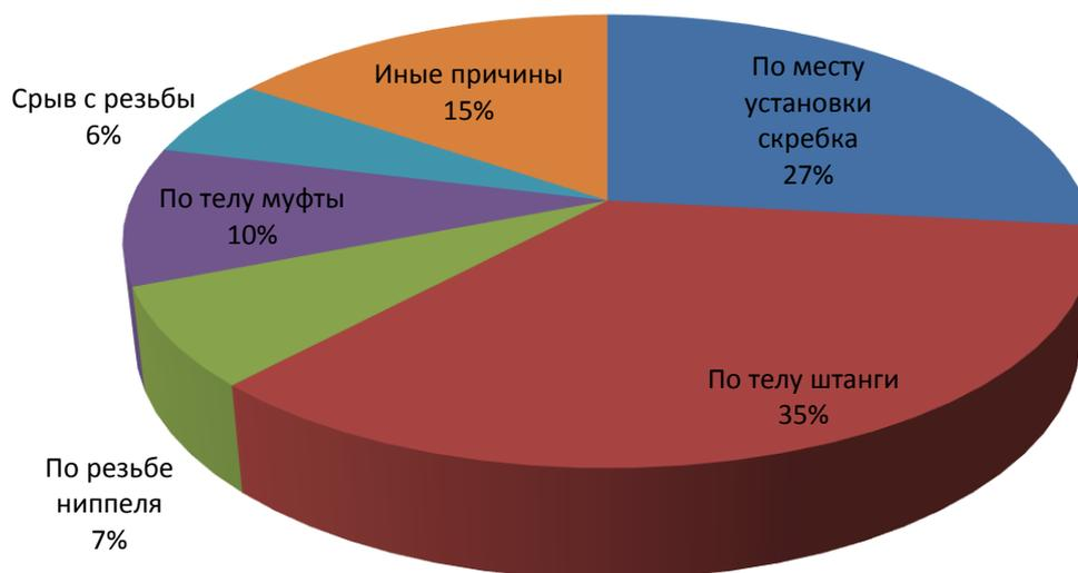
Рисунок 1.4.9 - Участки разрушения колонны штанг
