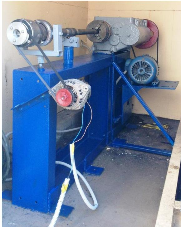
Рисунок П.В.3 - Стендовая установка для испытания насосных штанг на выносливость
