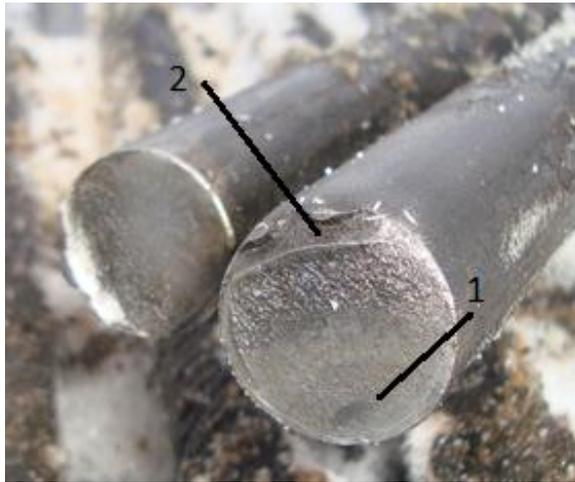
Рисунок 1.4.6 - Обрыв колонны штанг по гладкой части в результате усталостного разрушения (1-зона распространения трещины, 2-зона долома)
