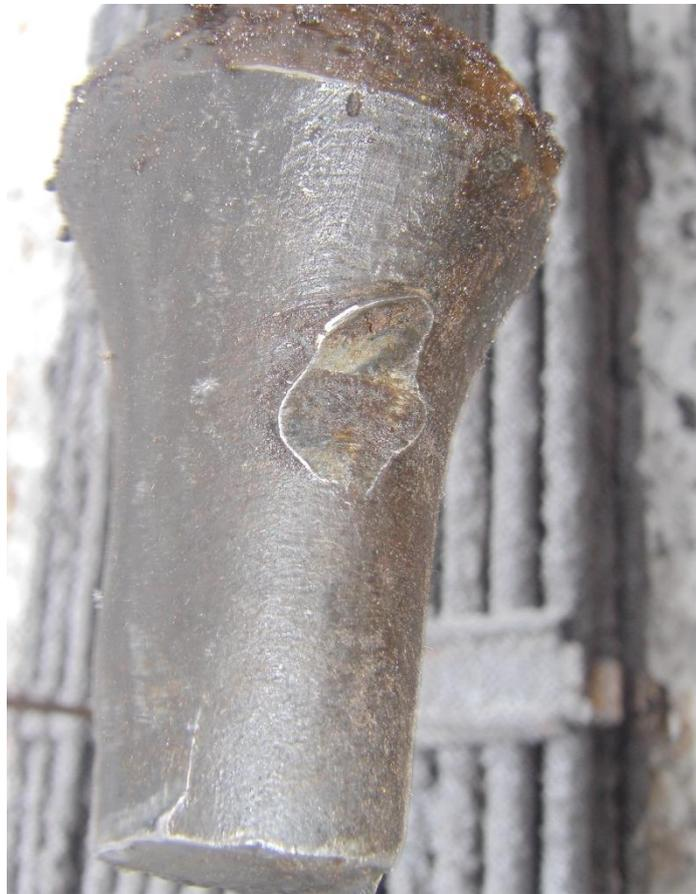
Рисунок 1.4.7 - Обрыв колонны штанг в галтельной части
