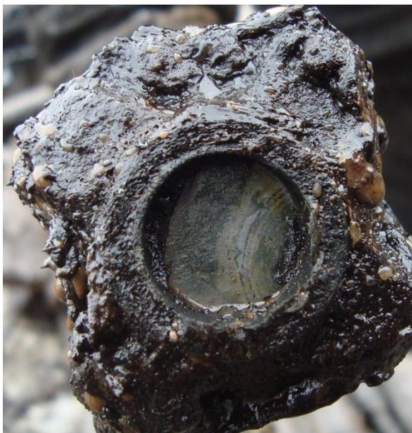
Рисунок 1.4.8 - Обрыв колонны штанг в месте установки центратора
