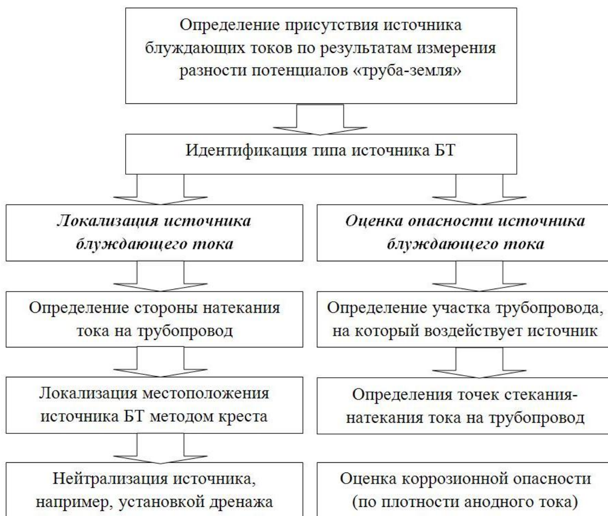
Рисунок 1.15 – Последовательность реализации мероприятий по противодействию БТ на действующих подземных нефтегазопроводах
