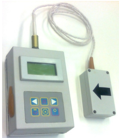
Рисунок 3.5 – Внешний вид основной части измерительного комплекса БИТА-2: блок управления, обработки, накопления данных (слева) и однокомпонентный датчик магнитного поля (справа)
