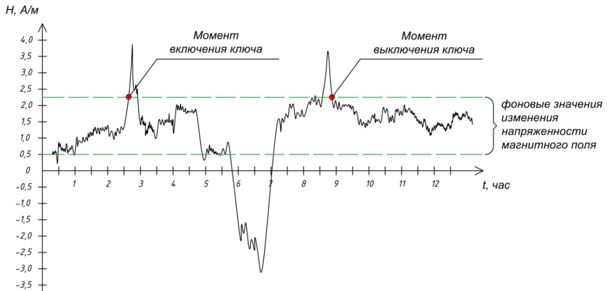
Рисунок 4.11 – График напряженности поля с указанием моментов времени замыкания-размыкания цепи подключения протектора
