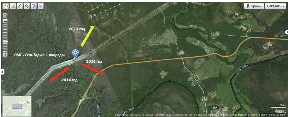
Рисунок 3.2 – Результаты определения направления действия источника БТ (показано стрелками), полученные специалистами ООО «Газпром трансгаз Ухта» в 2013 – 2014 гг.
