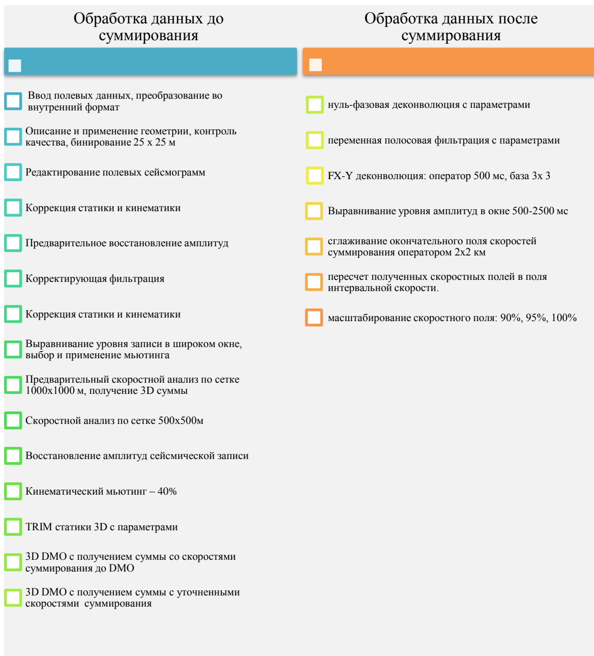
Рисунок 2.1 – Схема оцифровки сейсмических данных
