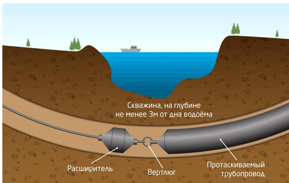
Рисунок 1.6 – Схема протягивания рабочей плети трубопровода
