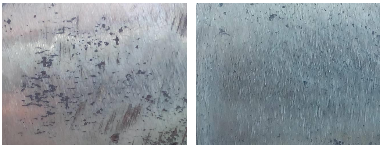
Рисунок 2.12 – Участки контроля до вышлифовки: а) дефектный участок; б) бездефектный участок
