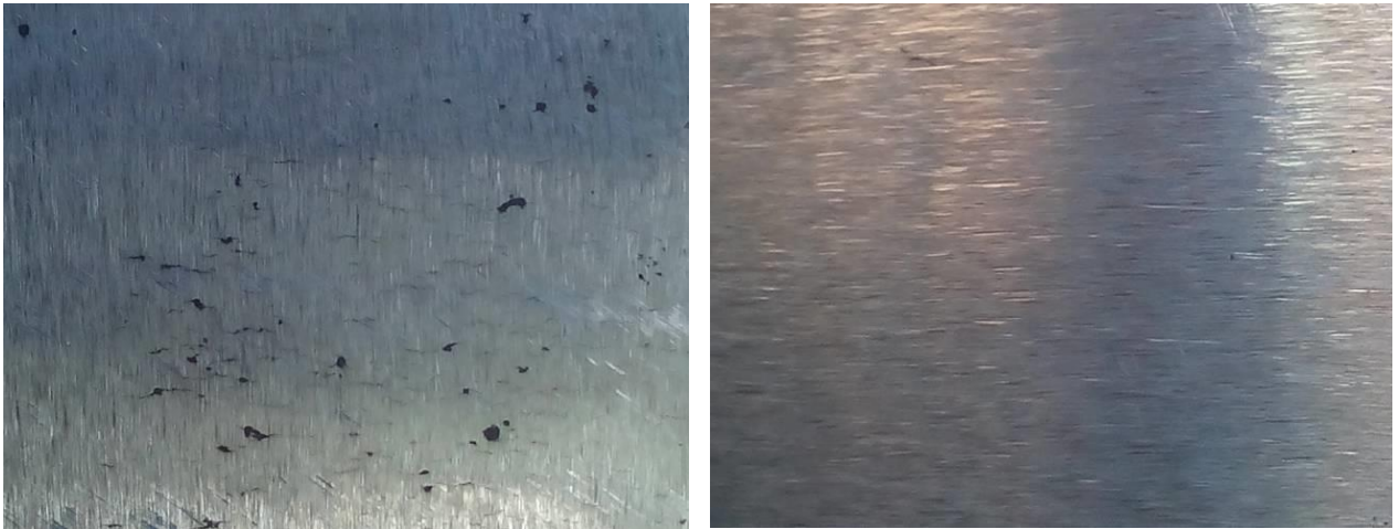
Рисунок 2.13 – Участки контроля после вышлифовки: а) дефектный участок; б) бездефектный участок
