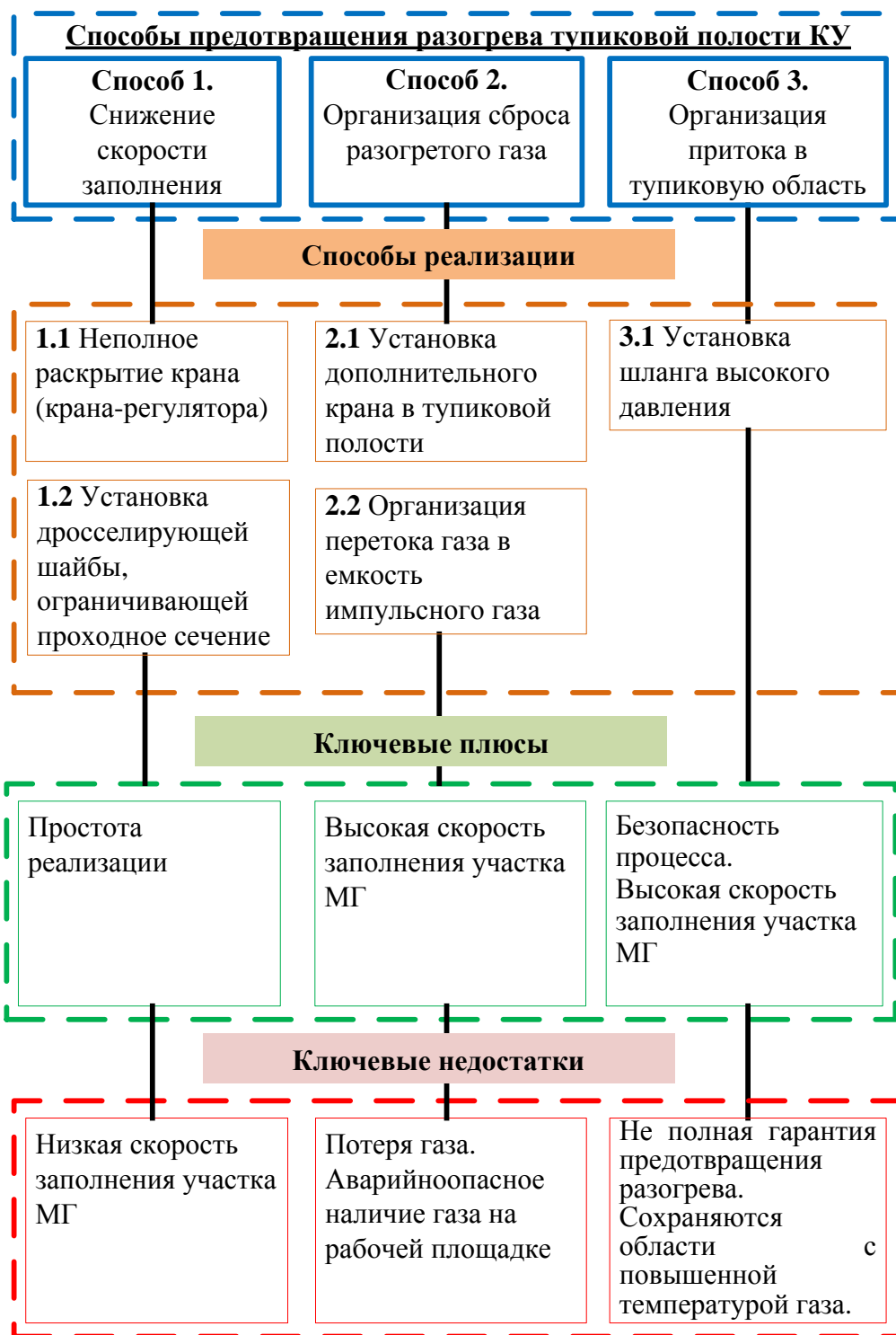
Рисунок 1.15. Классификация известных способов предотвращения разогрева тупиковых полостей КУ
