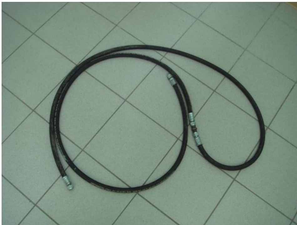
Рисунок 1.20. Шланг высокого давления, используемый для организации перемычки между стояками
