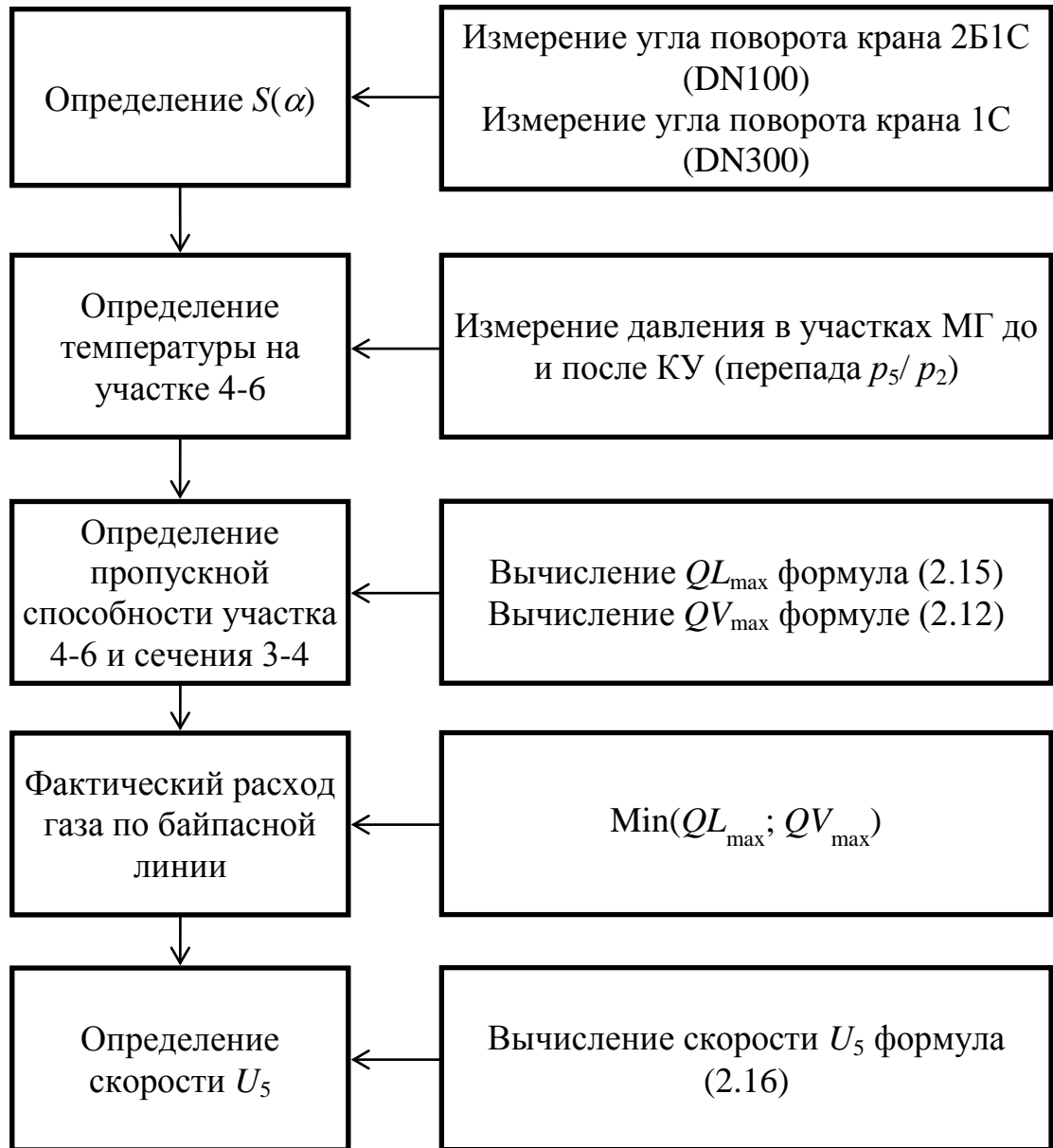
Рисунок 2.36. Алгоритм определения скорости движения газа по байпасной линии в окрестности тупиковой полости
