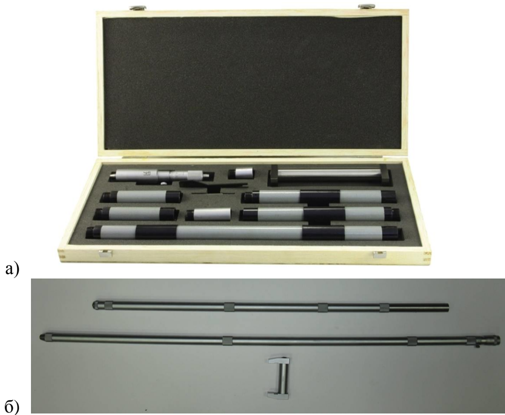
Рисунок 2.4 – Нутромер НМ 50 – 1300 в разобранном а) и собранном виде б)
