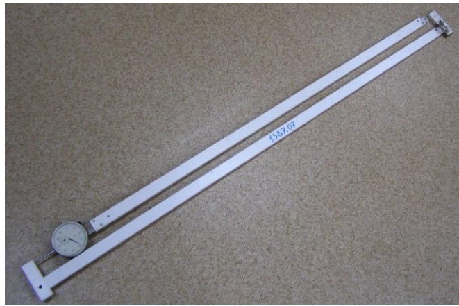
Рисунок 2.6 – Калибровка нутромера для трубы сечением 1420 мм эталонной мерой
