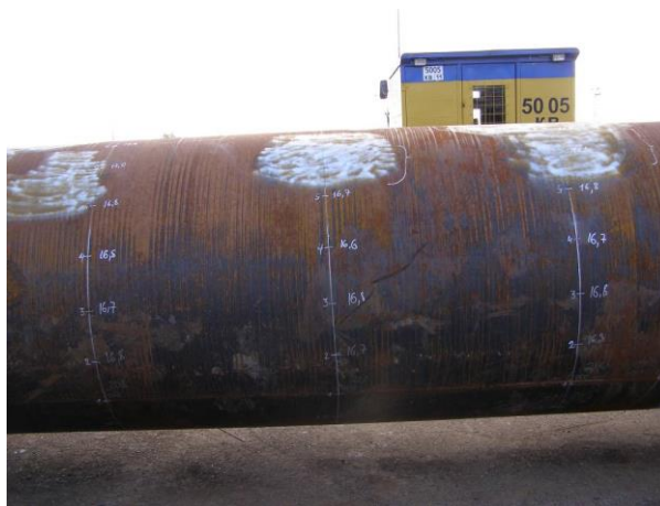
Рисунок 2.9 - Значения толщины стенки в контрольных точках средней части трубы
