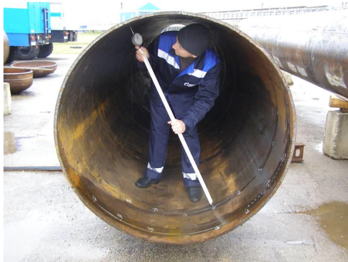
Рисунок 2.5 – Рабочий момент измерения внутреннего диаметра трубы нутромером
