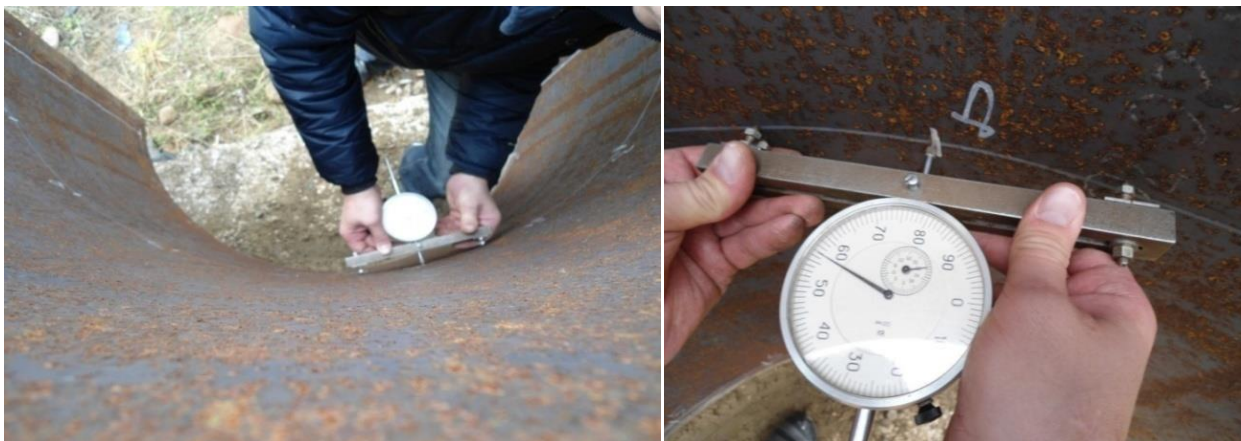
Рисунок 2.12 –Измерение кривизны внутренней поверхности полумуфт
