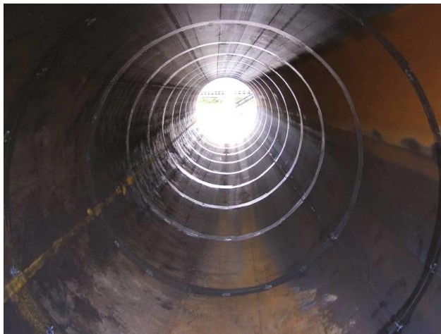
Рисунок 2.3 – Контрольные сечения на внутренней поверхности трубы № 12991
