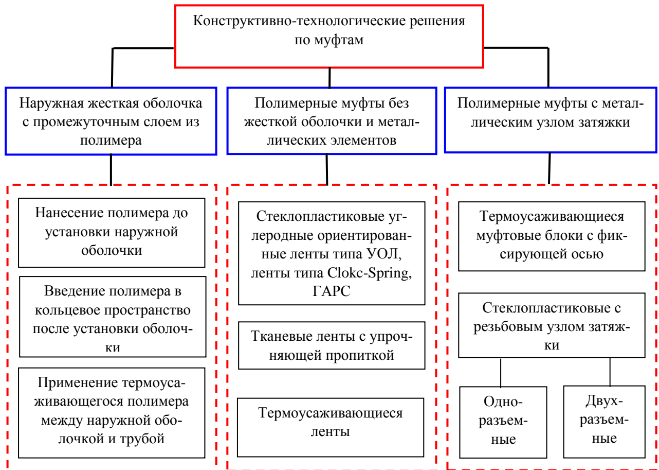
Рисунок 1.1 - Классификация решений по муфтовым конструкциям и технологиям
