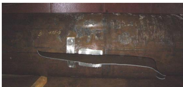
Рисунок 1 – Общий вид разрушения испытательной плети
