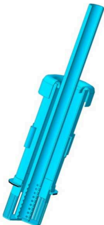
Рисунок 5 – Схема расположения секущих плоскостей для измерения параметров потока в прямоточном центробежном массообменном элементе с центральной трубкой.
