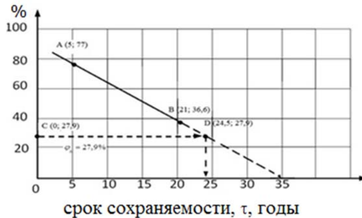
Рисунок 12. Графическое прогнозирование предельного срока сохраняемости защитного покрытия труб по контролируемому параметру твердости
