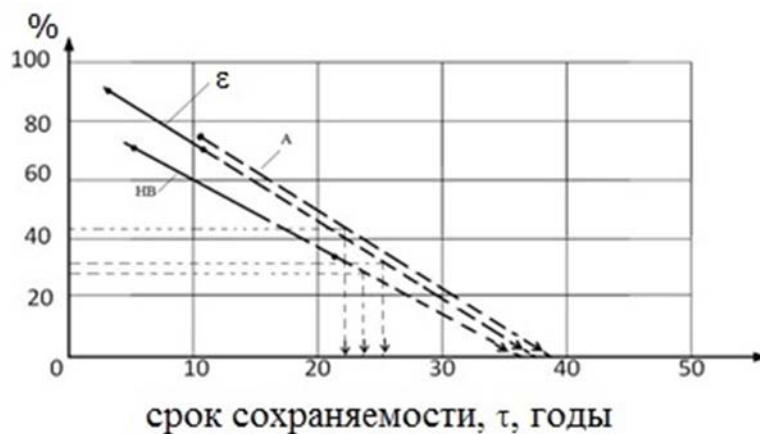
Рисунок 13. Совмещенный график прогнозной оценки предельного срока сохраняемости защитных покрытий труб по контролируемым параметрам: НВ – твердости; \varepsilon – относительному удлинению; А – адгезионной прочности
