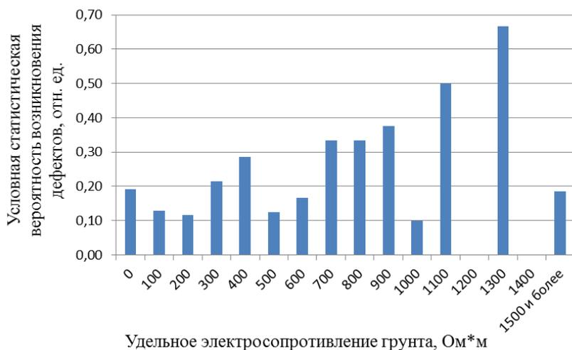
**Рисунок 4 – Гистограмма распределения условной вероятности возникновения дефектов КРН от удельного электросопротивления грунта**
