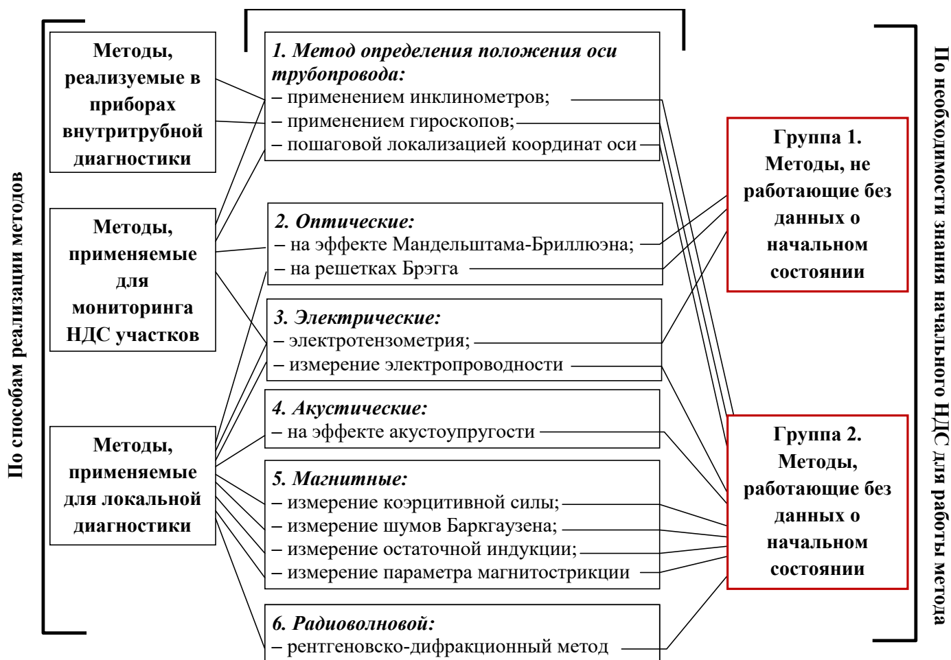
Рисунок 1 – Классификация методов неразрушающего контроля напряженного состояния трубопроводов по видам НК (согласно ГОСТ 56542-2015 кроме п.1)
