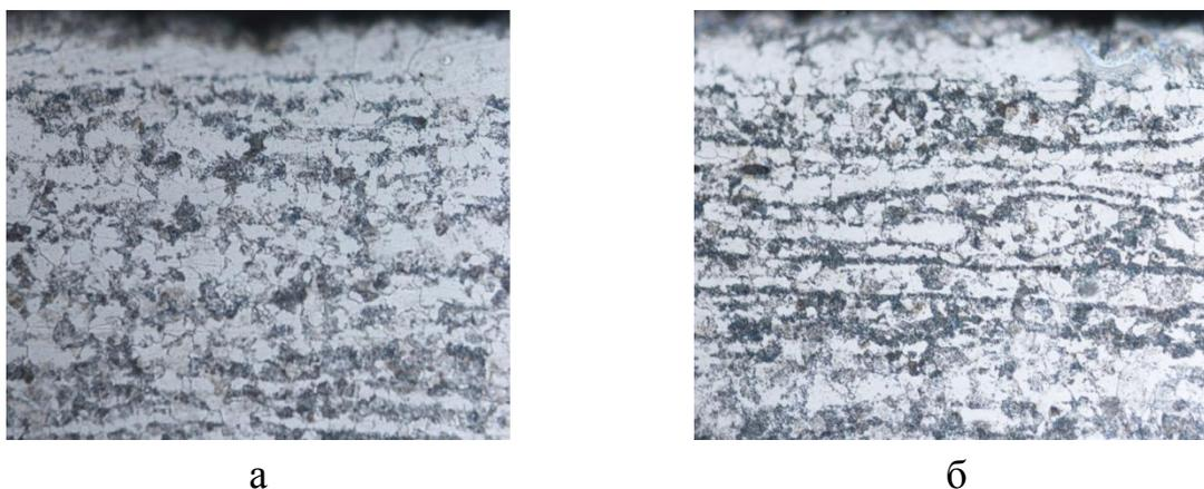
Рисунок 6 - Структура поверхностного слоя полый насосной штанги (увел. x500): а - поверхностный слой без приложения нагрузки; б -поверхностный слой после приложения нагрузки
