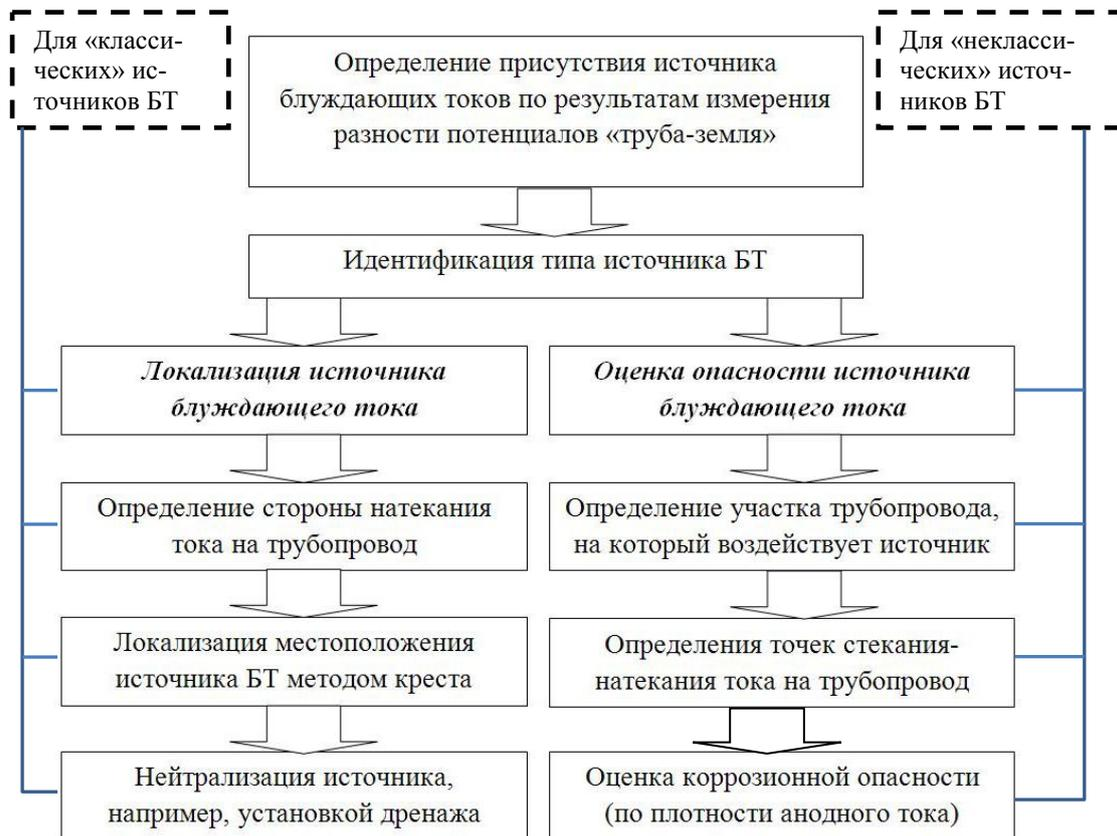
**Рисунок 1** – Последовательность реализации мероприятий по противодействию блуждающим токам на подземных нефтегазопроводах
