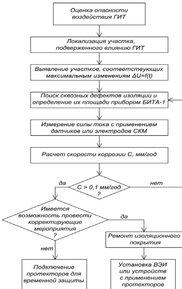
**Рисунок 12** – Алгоритм оценки и устранения риска коррозионного разрушения трубопровода под воздействием ГИТ
