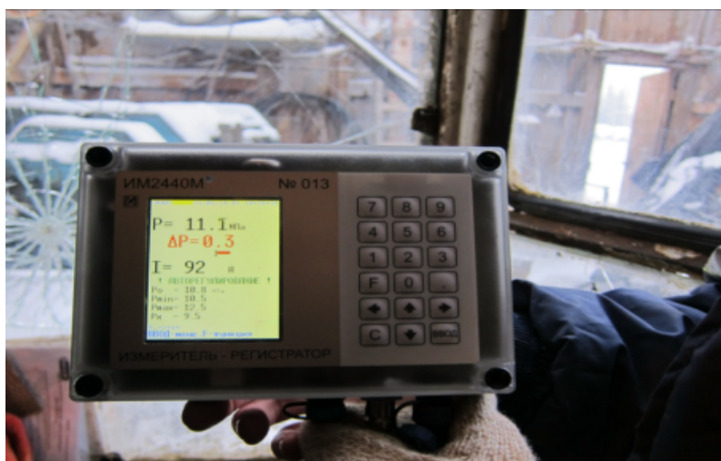
Рисунок 7. Общий вид узла управления регулятором подачи долота ИМ2440М
