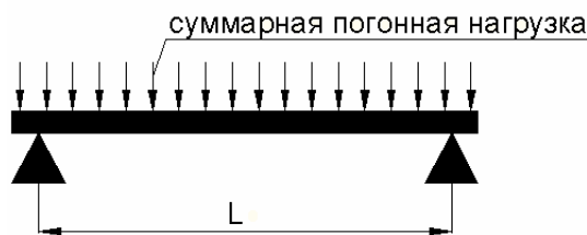
Рисунок 2.15 – Простейшая расчетная схема трубы - футляра (балочная постановка)
