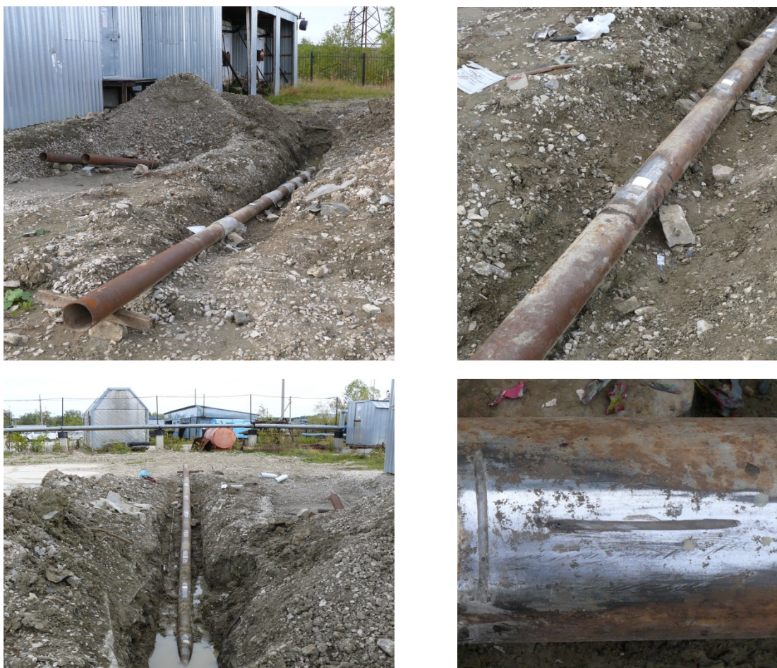
Рисунок 3.17 – Экспериментальный стенд для отработки дальнедействующего ультразвукового контроля
