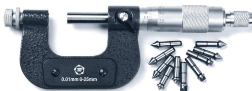
Рисунок 2.1 – Микрометр со вставками МВМ 0–25
