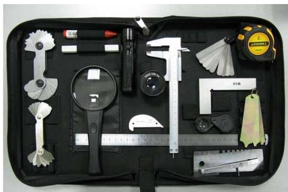
Рисунок 2.4 – Комплект для проведения визуального и измерительного контроля ВИК–1А
