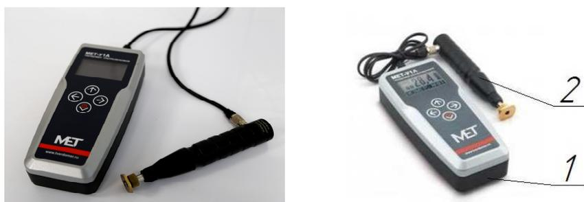
1 – блок электронный; 2 – датчик ультразвуковой У1
