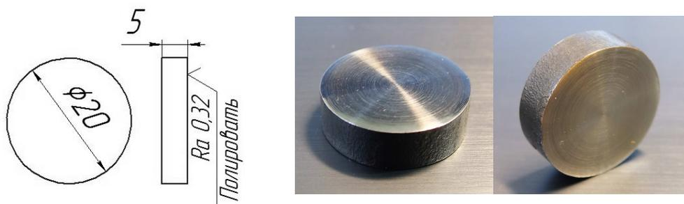
Рисунок 3.2 – Образец для проведения твердометрии
