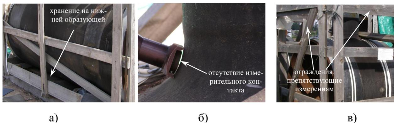
Рисунок 3.26 – Характерные недоступные для контроля зоны тройника: локальные участки покрытия, в которых не были проведены измерения (а, б, в)
