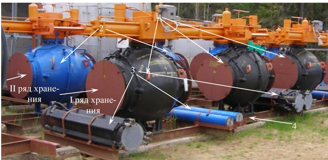
1 – шаровые краны с защитным покрытием; 2 – шаровые краны без покрытия (окрашенные); 3 – стойка привода; 4 – металлические подставки
