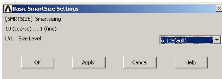
Рисунок 3.7 – Задание параметров автоматической генерации сетки
