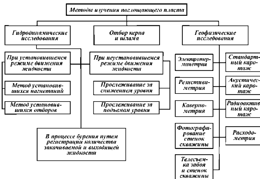
Рисунок 2.4 – Классификация методов изучения поглощающих пластов (по В.И. Крылову) [70, 71]
