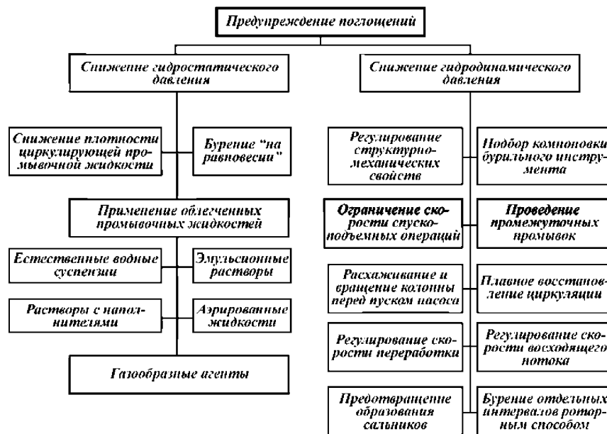
Рисунок 2.8 – Схема факторов, обуславливающих снижение гидростатического и гидродинамического давления на стенки скважины
