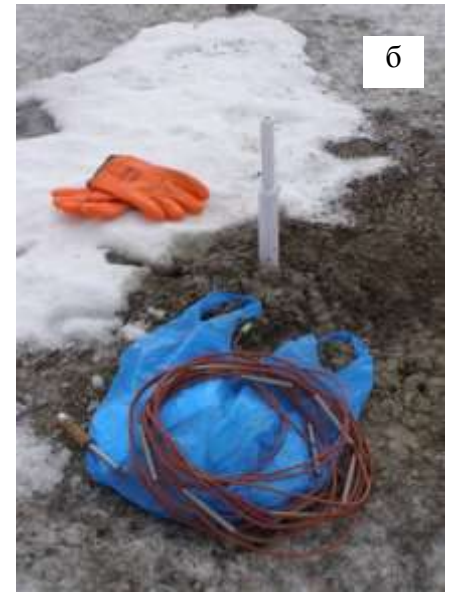
Рисунок 2.10 – Определение температуры многолетнемерзлого грунта: а) размещение термоизмерительной косы в скважине; б) выдержка термоизмерительной косы на воздухе перед спуском в скважину
