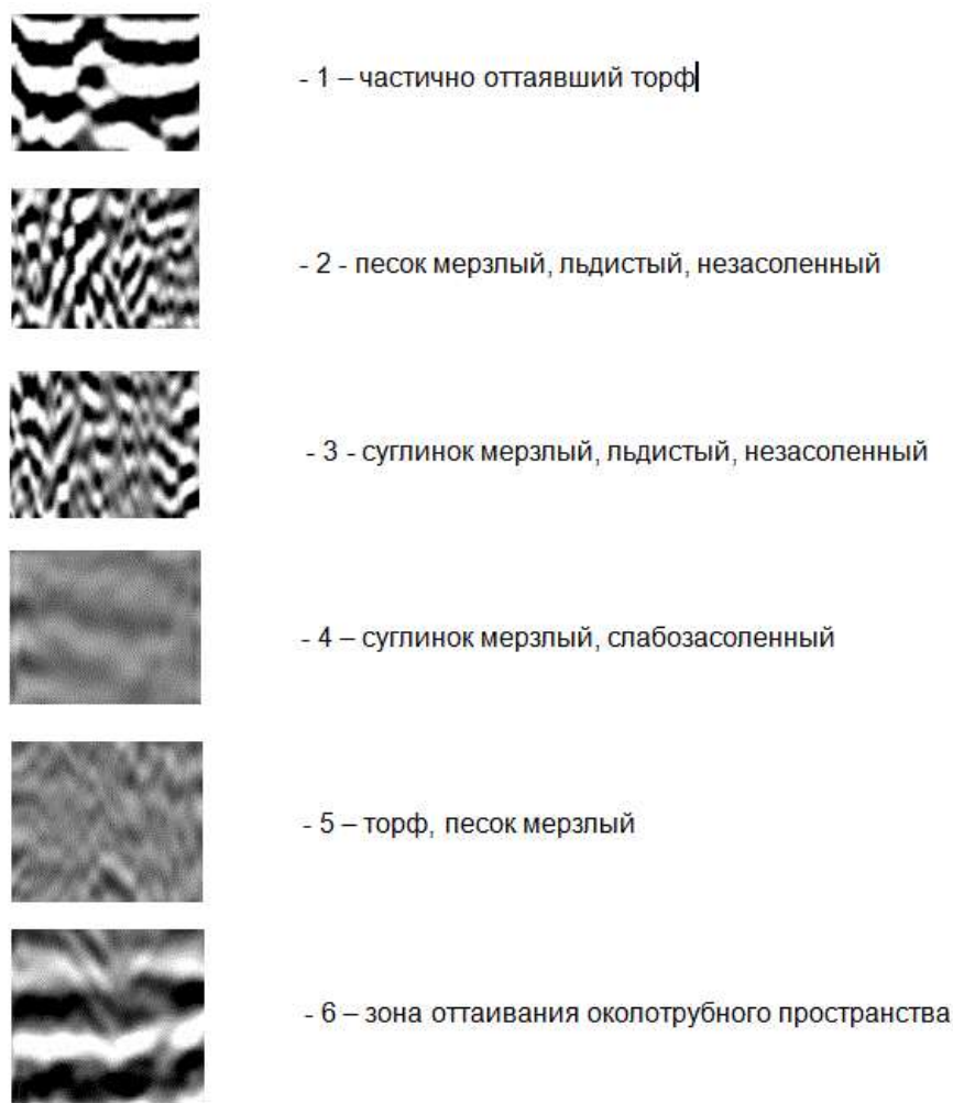
Рисунок 3.21 – Особенности формирования волновой картины на радиограммах, в зависимости от типа и состояния грунта (25,3 км)
