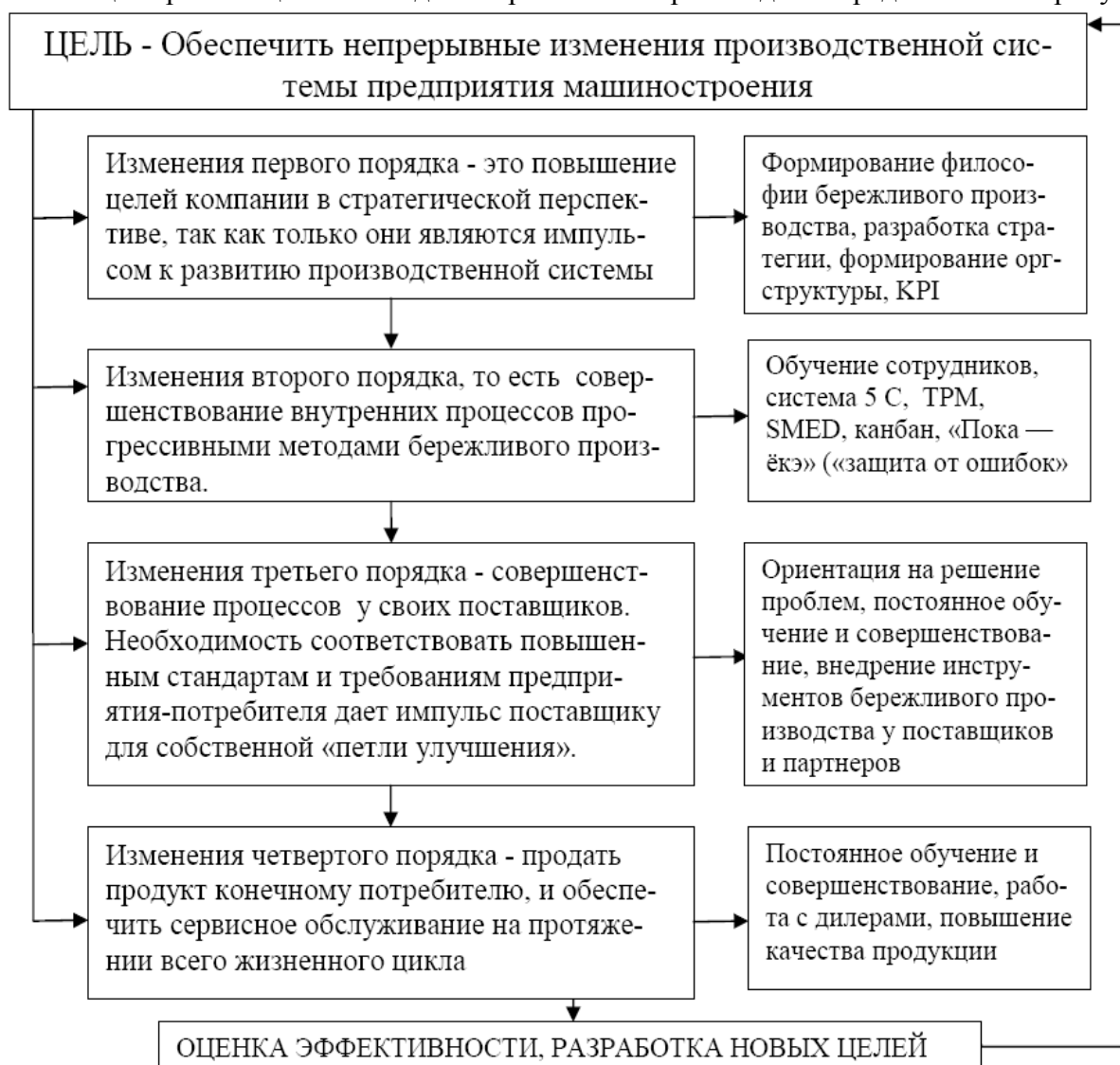
Рисунок 3 - Организационная модель бережливого производства на производственном предприятии
