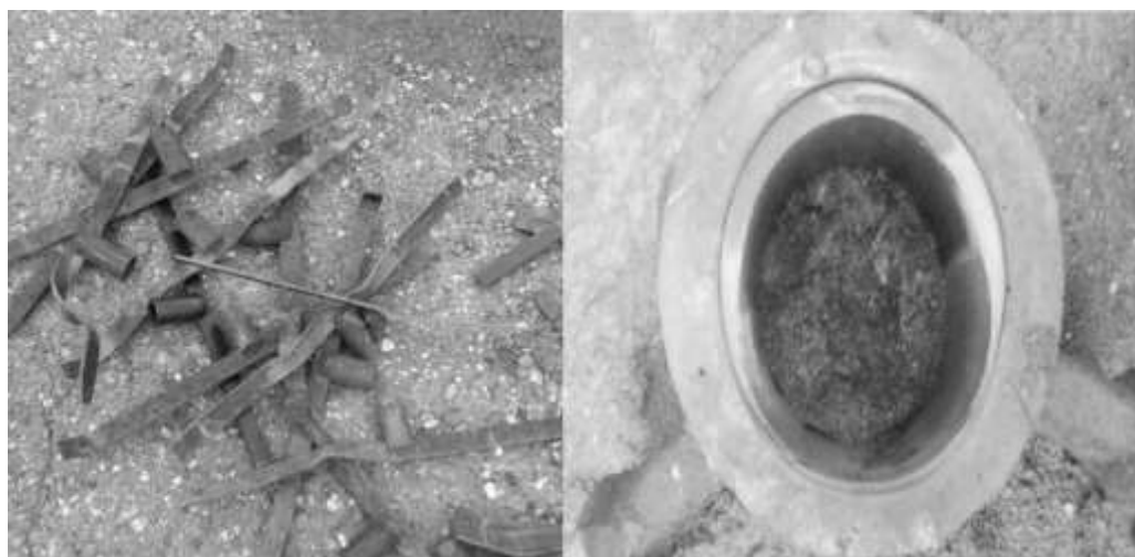
Рис. 3. Деформированные скребки и износ тройникового подшипника.
