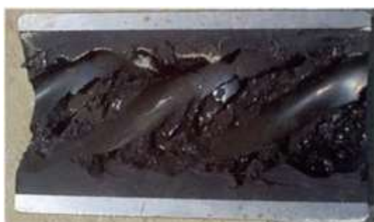
Рисунок 4–Разрушение эластомера статора в результате действия высокого перепада давления
