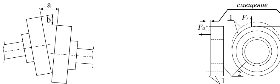
а – определение уровня расцентровки б – определение уровня дефекта подшипника 1,2 – наружная и внутренняя обоймы
