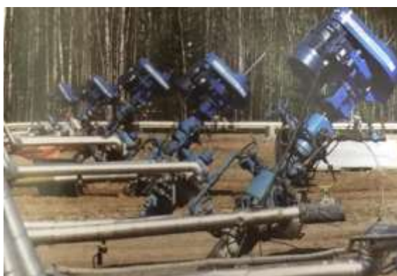
Рисунок 6-Установки винтовых насосов PCM Vulcan на месторождениях Joslyn (Канада)
