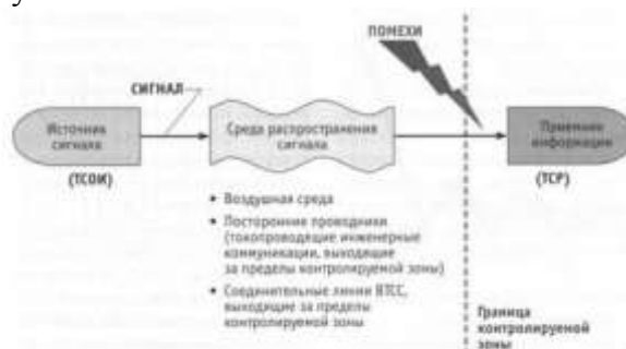
Рис. 1. Схема технического канала утечки информации
