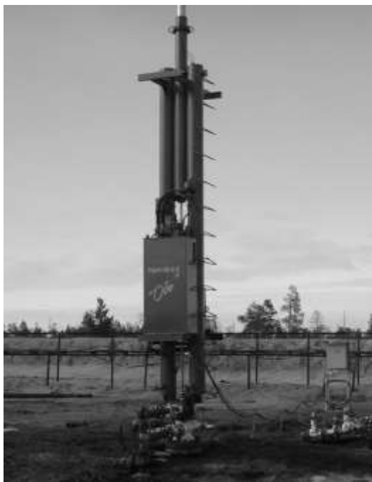
Рис. 7. Общий вид гидропривода ПШН-80×2,5 «Обь»
