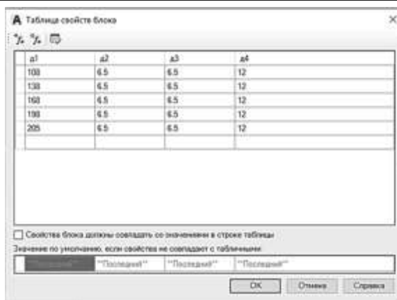
Рис. 7. Создание и заполнение Таблицы свойств блока
