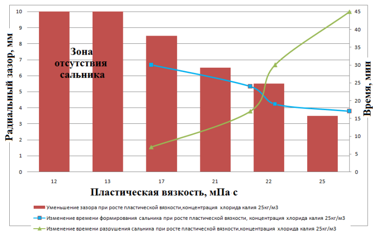
Рисунок 3.16 - Изменение радиального зазора в скважине при росте пластической вязкости в процессе наработки коллоидной фазы в растворах различной минерализации.
