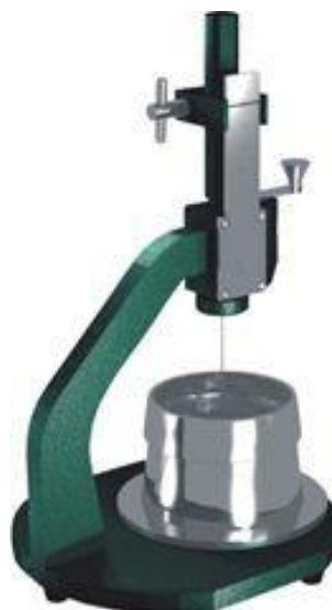
Рисунок 2.4 – прибор игла Вика ИВ-2, общий вид
