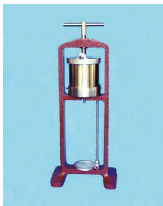
Рисунок 2.2– пресс-фильтр производства Ofite
