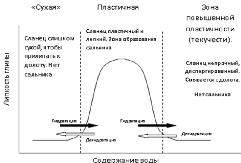
Рисунок 3.13 Влияние влажности глинистой породы на образование сальника.
