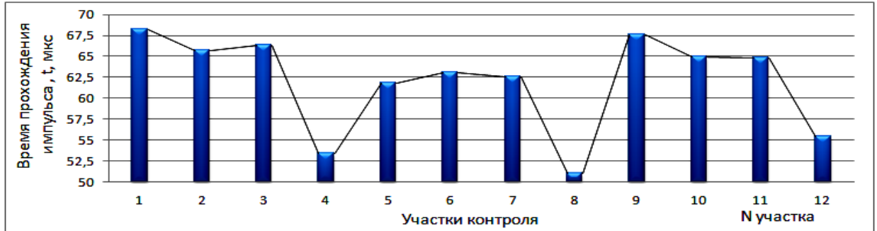
Рисунок 13 – График изменения времени прохождения УЗ сигнала по результатам сквозного прозвучивания по боковым поверхностям модели №1 по стороне А-В
