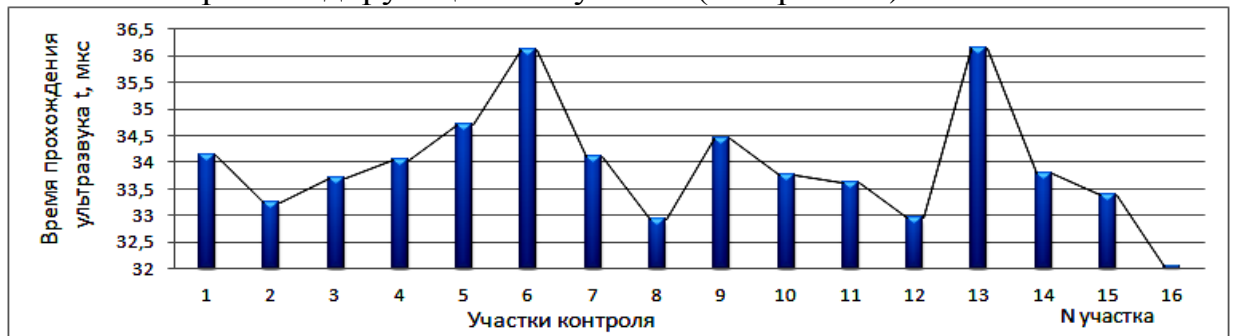
Рисунок 15 – График изменения времени прохождения УЗ сигнала по результатам поверхностного прозвучивания по боковым поверхностям модели №1
