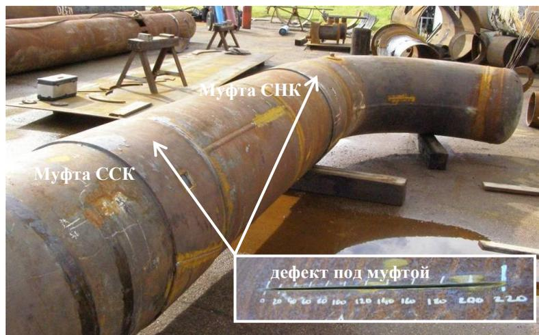
Рисунок 10 – Объект испытаний с установленными сварными муфтами
