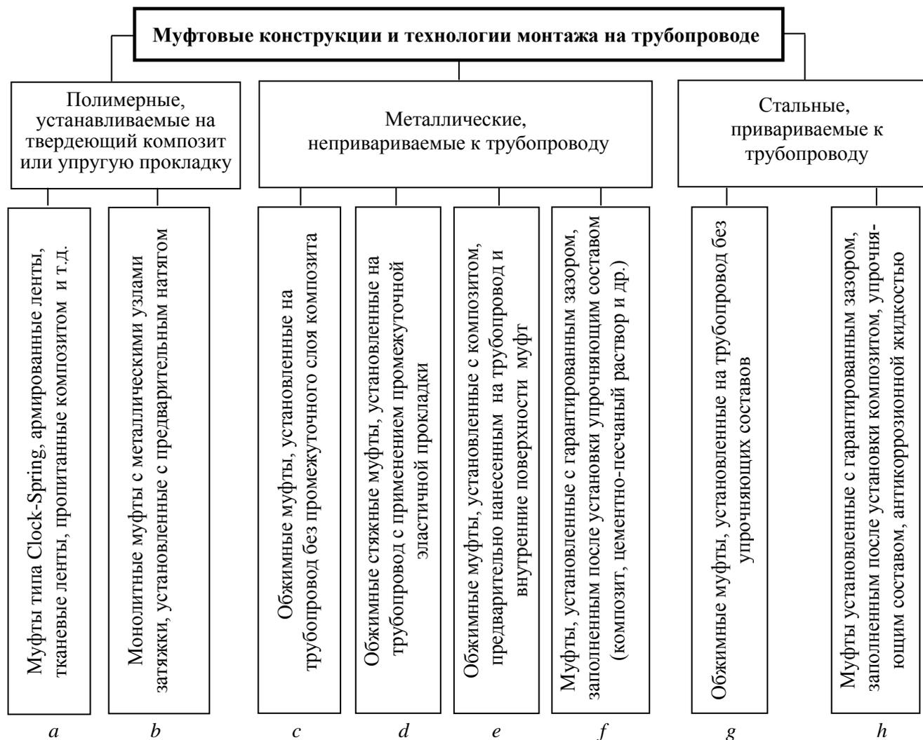
Рисунок 1 – Классификация конструктивно-технологических решений по ремонту трубопроводов с применением муфт
