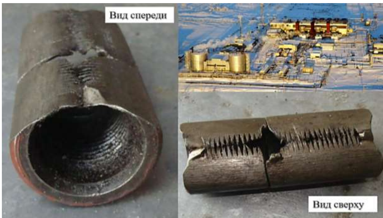
Рисунок 5 – Элемент обрыва колонны штанг скважины №811 Новонадымского месторождения.
