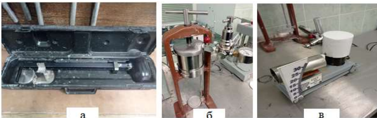
а – рычажные весы фирмы Ofite; б – фильтр пресс фирмы Fann; в - прибор КТК- 2
