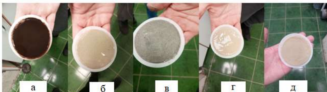
а- образец с Atren SL; б – образец с микан Д; в- образец с графитом; г – образец с Alpine Drill Beads; д- образец с полиэколуб
