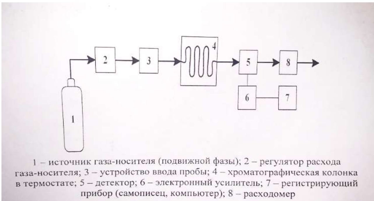
Рисунок 1. Устройство газового хроматографа.
