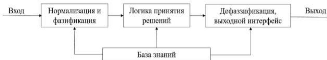
Рисунок 1 – Конфигурация типичного FLC.
