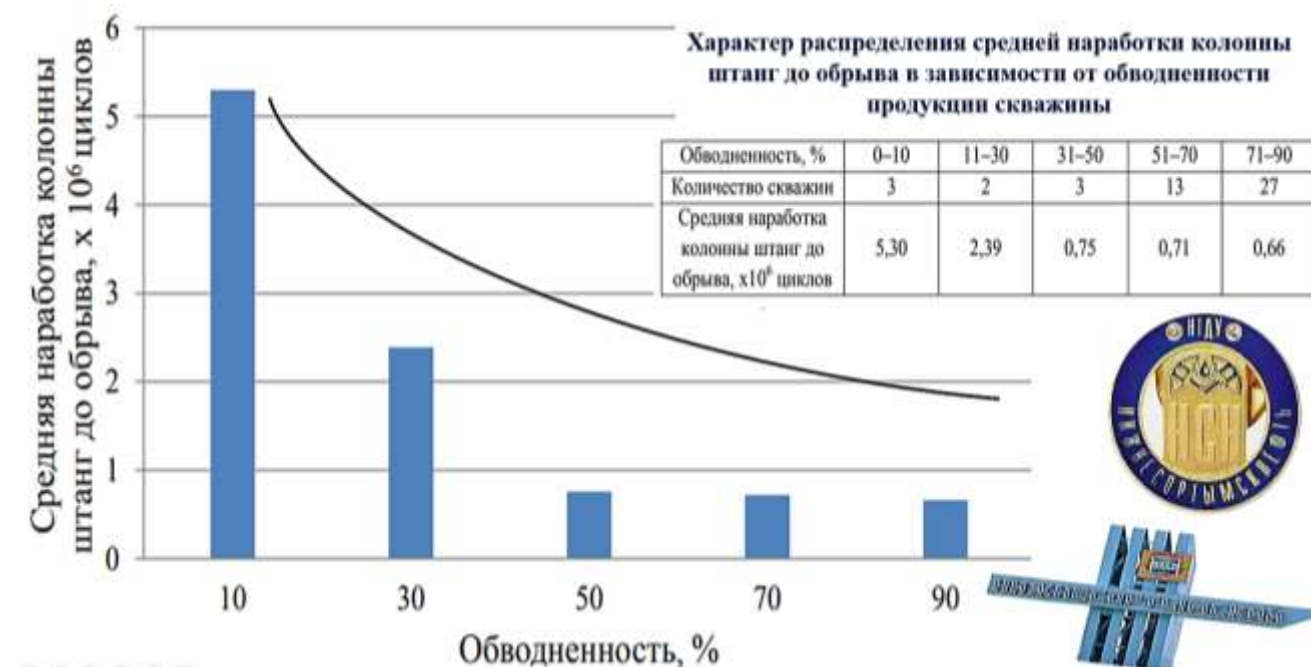
Рисунок 4 – Статистическая информация распределения количества обрывов колонны штанг в зависимости от обводненности продукции скважин в НГДУ «Нижнесортнымскнефть» за 2020–2023 годы.
