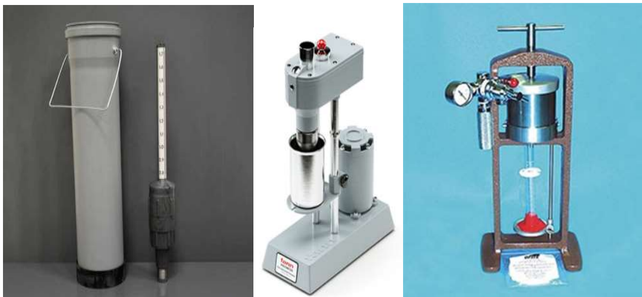
(ареометр, реометр FANN SA-35, фильтр-пресс FANN с модулем давления CO 2 )
