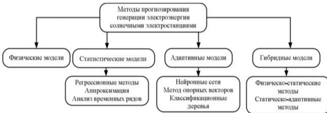
Рисунок 1 – Классификация методов прогнозирования генерации электроэнергии солнечной электростанции.
