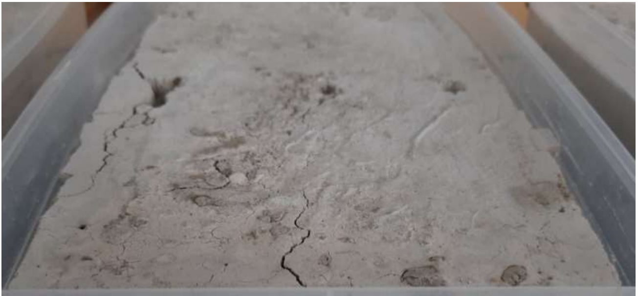
Рисунок 2 – Эксперимент по влиянию прогрева бетона на трещинообразование.
