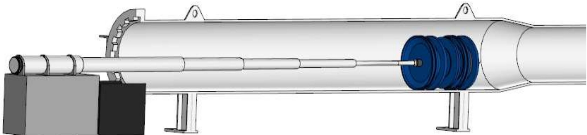
Рисунок 1.9 – 3D визуализация конечного положения запосовочного устройства в камере пуска.
