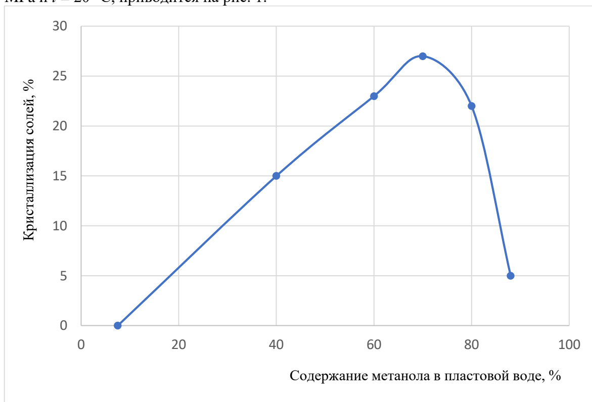
Рис. 1- Степень кристаллизации солей из растворов метанола в пластовой воде
