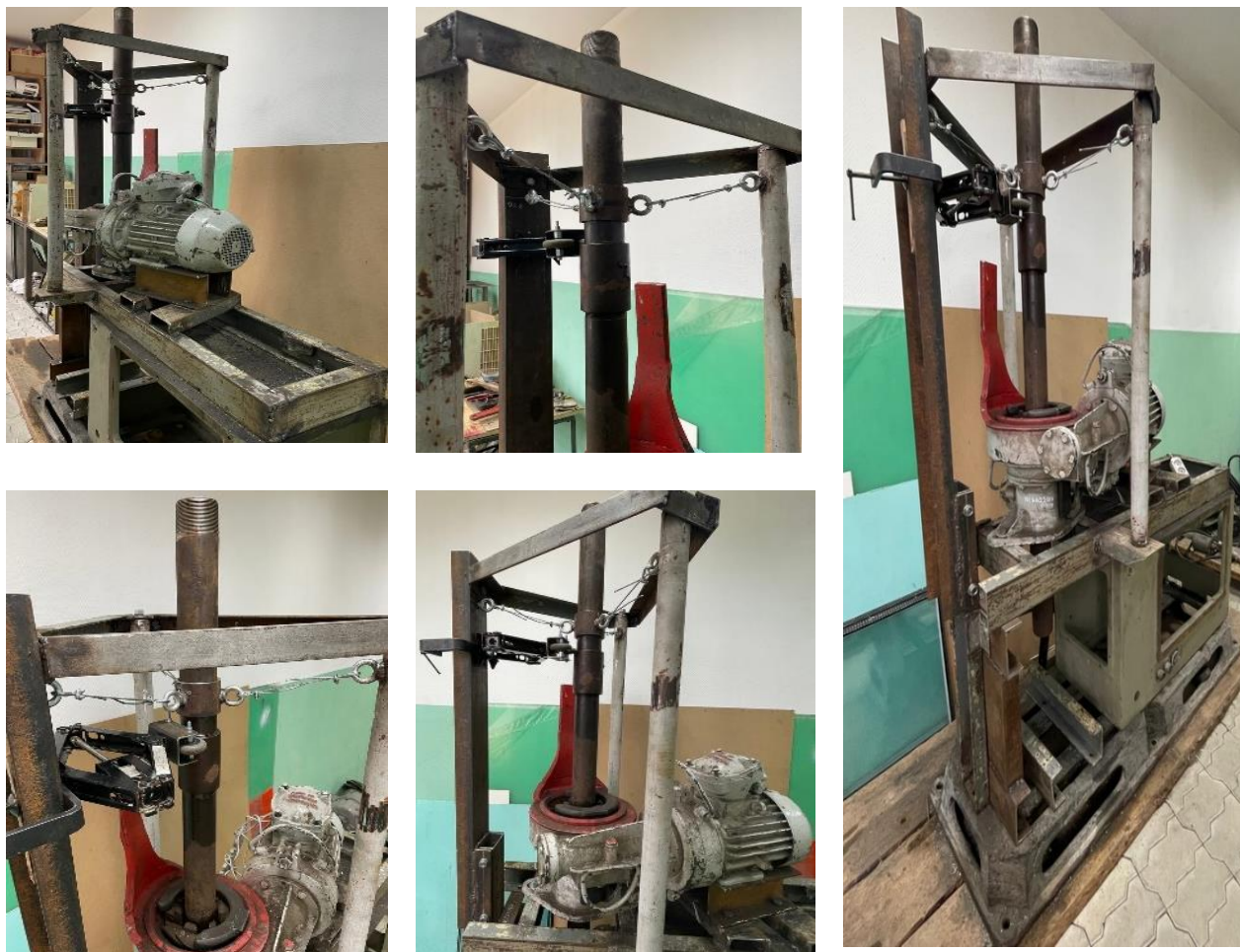
Рис. 3 - Конструкция экспериментального стенда для проведения испытаний на свинчивание-развинчивание труб НКТ
