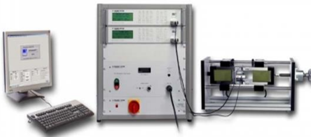
Рис. 5 - Remagraph C-500 – лабораторная высокоточная установка измерения (квази)-статических петель гистерезиса магнитомягких материалов
