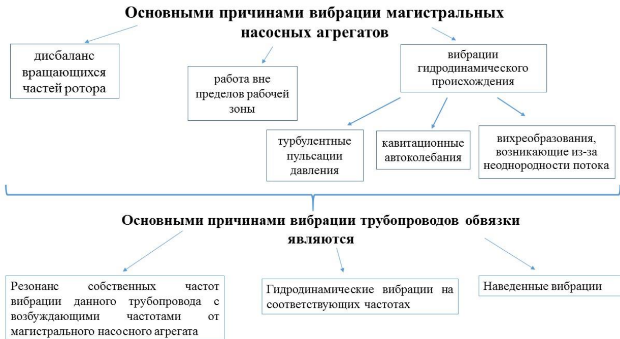
Рис. 2 – Схема основных причин вибрации в системе «магистральный насос – трубопровод обвязки»
