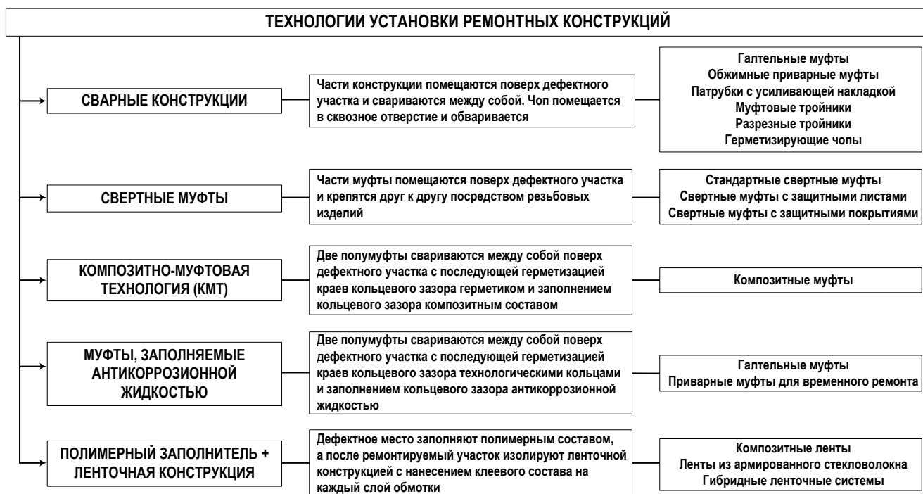
Рис. 2 – Классификация технологий установки ремонтных конструкций
