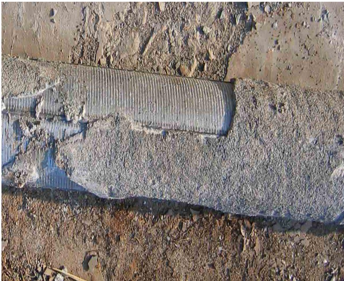
Рис. 1 – Типовой вид закольматированного противопесочного фильтра.
