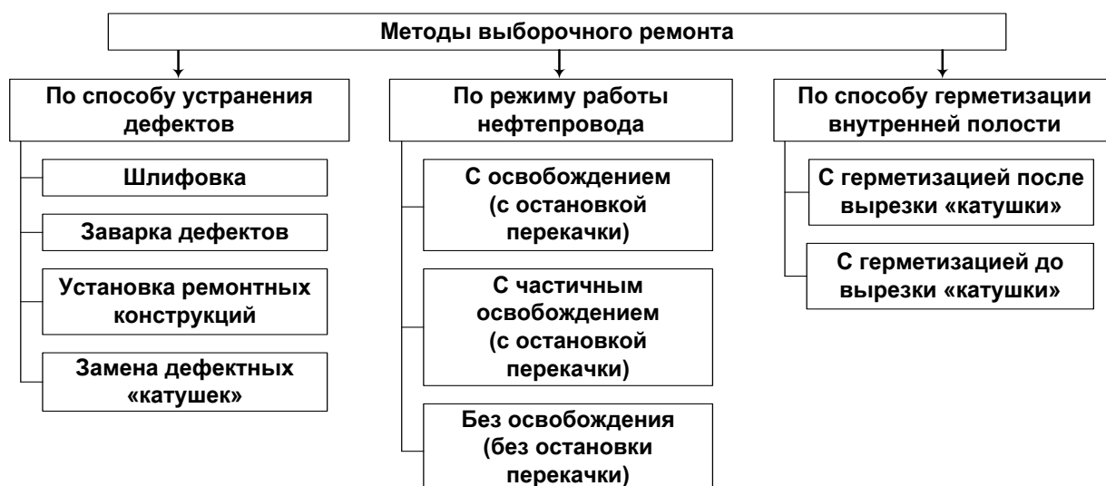
Рис. 1 – Классификация методов выборочного ремонта по технологическим особенностям
