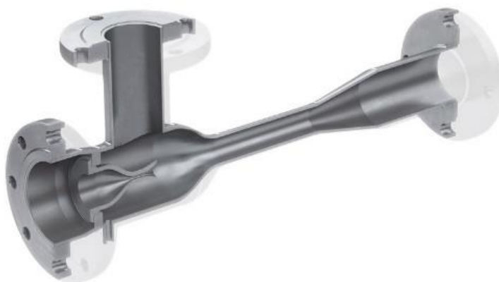
Рис. 1 – Схема газового эжектора в разрезе
