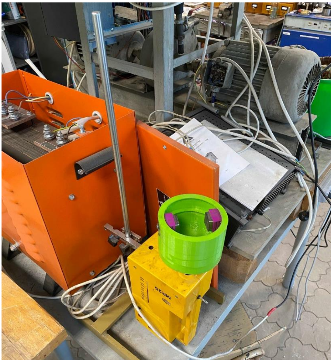
Рис. 5 – Экспериментальная установка вращающегося магнитного поля с постоянными магнитами
